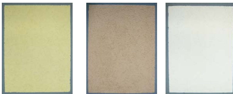
Figura 1. I campioni di intonaco fotocatalitico nelle tre colorazioni testate
