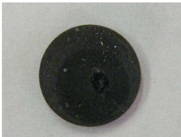
**Figura 4. 46 Immagine di un campione di RuO<sub>2</sub> su grafite con la presenza del foro formatosi durante le misure di voltammetria**
