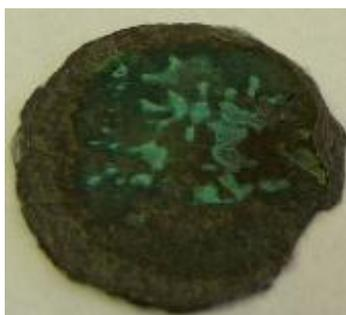
**Figura 4.5 Strato superficiale di un campione con un deposito irregolare di colore verde imputabile alla formazione di idrossocarbonati di cobalto.**
