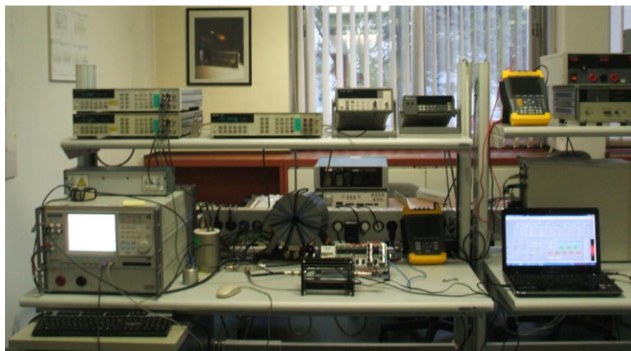
Figura 4.18: Sistema Nazionale Campione per la misura della potenza elettrica ed il sistema PC-SW in taratura
