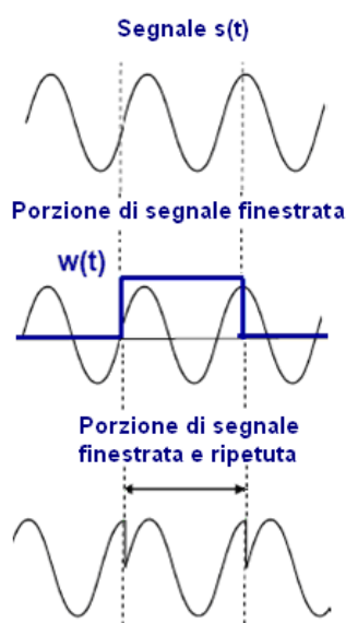
Figura 2.14: Discontinuità dovute alla finestratura.
