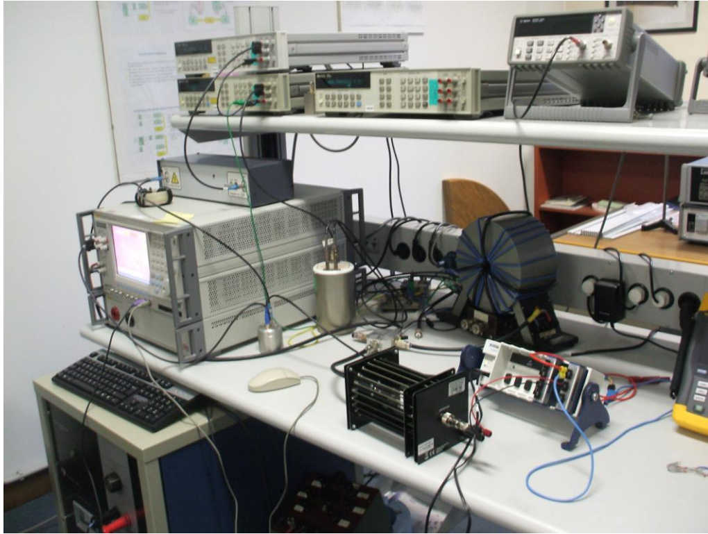
Figura 4.23: Confronto fra il sistema Nazionale Campione ed il PC Sampling Wattmeter
