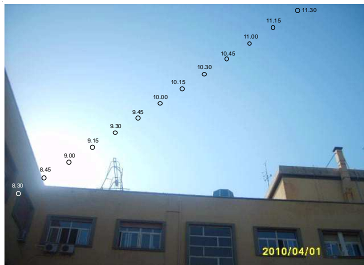
Fig.49. Confronto tra a) le posizioni del sole in coordinate cilindriche e b) quelle calcolate con il metodo fotografico il 1° aprile 2010.
