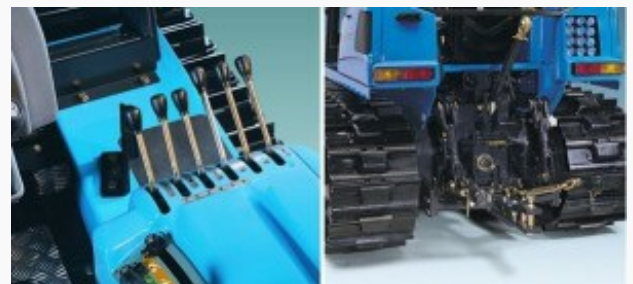
Comandi idraulici su trattore cingolata. Landini
