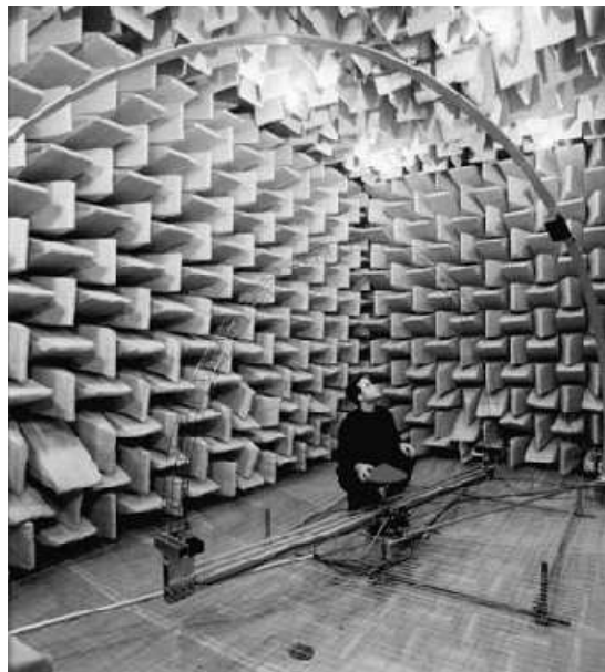
Figura 2.3: La figura mostra il sistema di misura della diffusione emisferica, in camera anecoica. Si vedono: arco esterno dove è posta la sorgente, un arco interno dove sono posti i microfoni, ed al centro il diffusore. (Tratta dal documento AES- 4id-2001).
