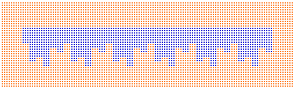
Figura 7.9: Implementazione discreta di un diffusore nell'ambiente di simulazione. I puntini in blu rappresentano il profilo del diffusore. Si noti la larghezza dei setti fissata a 3 punti. In questo caso si è rappresentato un PRD per N=7 ed n_p=6 .
