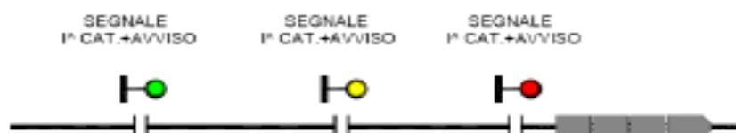
Fig. 3.2: Sistema di segnalamento a tre aspetti
