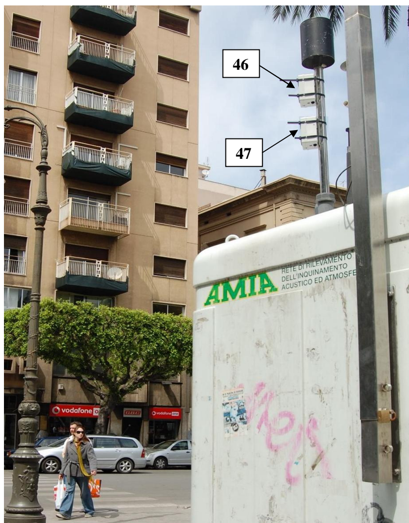
Figura 7.10 – Sensori “mote” collocati sulla Cabina di rilevamento “Castelnuovo”
