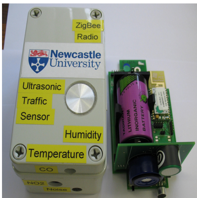
Figura 7.4 – Design interno ed esterno del sensore di rilievo ambientale “mote”
