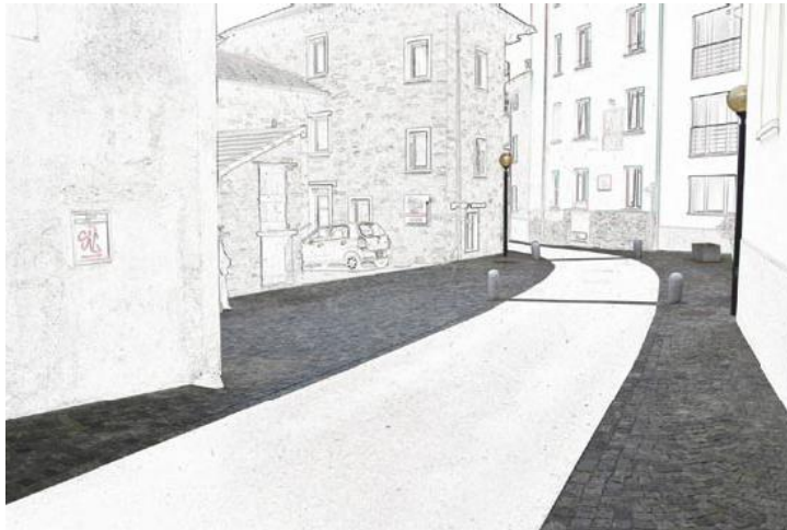
Figura 4.14 Esempio di restringimento della carreggiata
