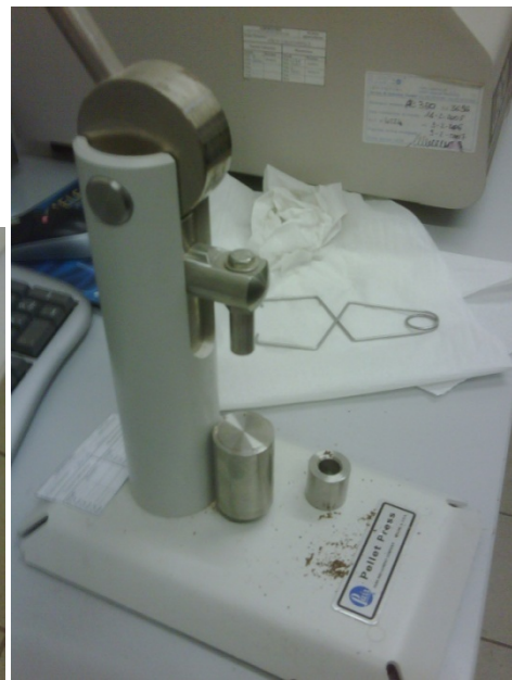
Figura 5.7 – Pressa impiegata in laboratorio per formare i Pellet
