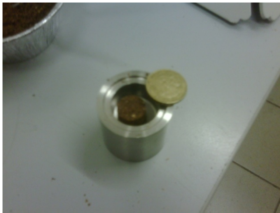
Figura 5.6 – Pellet impiegato per la prova di laboratorio con il calorimetro
