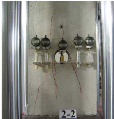
**Fig. 3-14 –Quadro fessurativo a rottura di un provino con foro centrato.**
