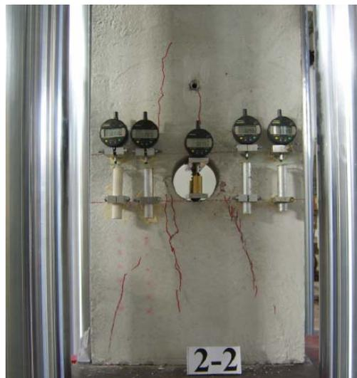
**Fig. 2-21 – Disposizione LVDTs sulla faccia del provino.**
