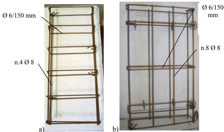
**Fig. 2-17 – Gabbie di armatura dei provini testati:**
