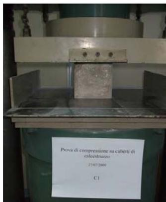
**Fig. 2-14 - Prova di rottura a compressione su cubetti di calcestruzzo.**
