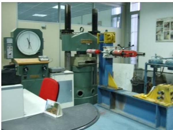
**Fig. 2-9 – Postazione di prova e posizionamento della carotatrice.**
