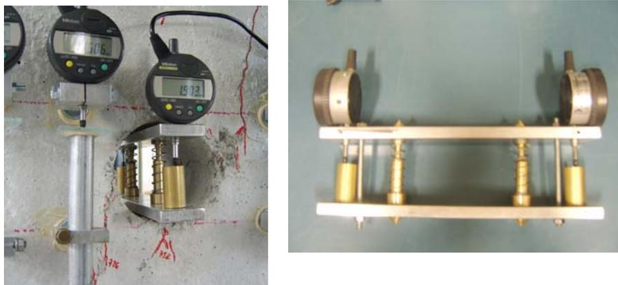
**Fig. 2-22 – Dispositivo per la misura delle distorsione del foro.**
