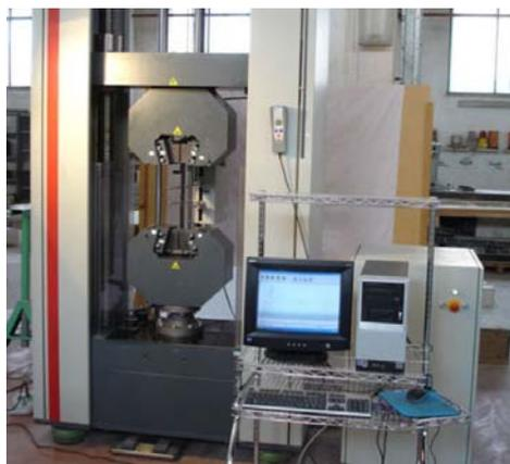
**Fig. 2-19 – Macchina universale Zwick/Roell da 600 kN.**
