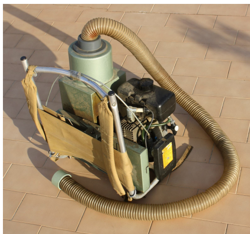
Figura 11: Aspiratore a motore modello Ilo 35 a benzina, impiegato per il monitoraggio delle comunità di artropodi nel meleo.
