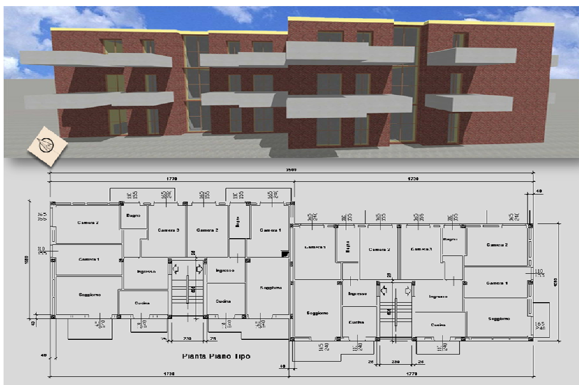
Figura 2.1 Planimetria piano tipo dell'edificio oggetto di studio
