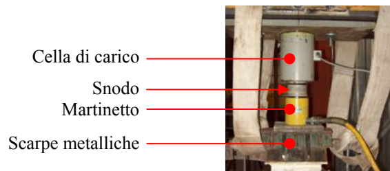
Fig. 5.25 – Dispositivo di applicazione del carico
