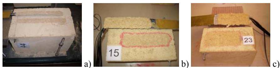
Fig. 3.81 – Prove single shear pushing test: tre diverse larghezze di una stessa tipologia di rinforzo
