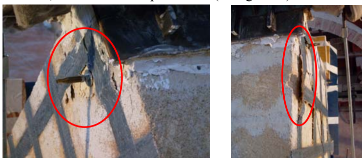
Fig. 5.29 – Instabilizzazione delle strisce di rinforzo in prossimità degli spigoli compressi del pannello
