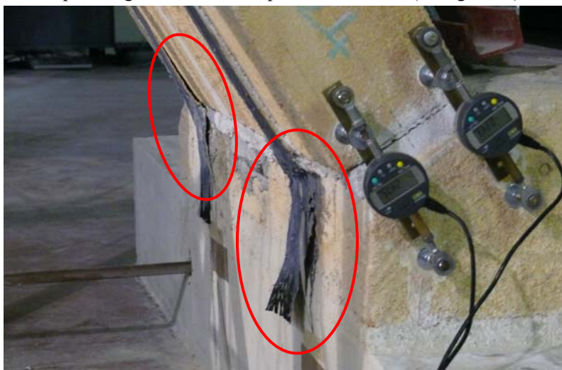
Fig. 4.45 – Perdita di aderenza delle strisce di rinforzo applicate sull'intradosso in prossimità dell'imposta di destra
