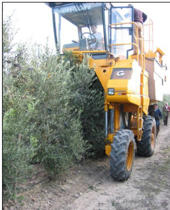
Figura VI – Macchina scavallatrice per la raccolta in continuo (Gregoire mod. G122)
