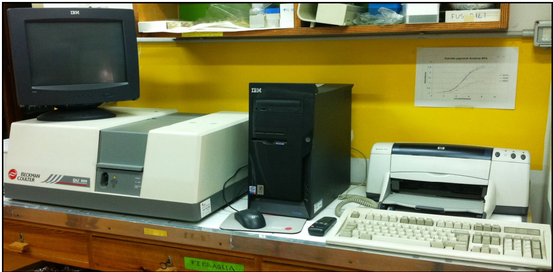
Fig. 1 - Spettrofotometro Beckman coulter DU 800 ( Laboratorio di Ecofisiologia vegetale di Palermo)
