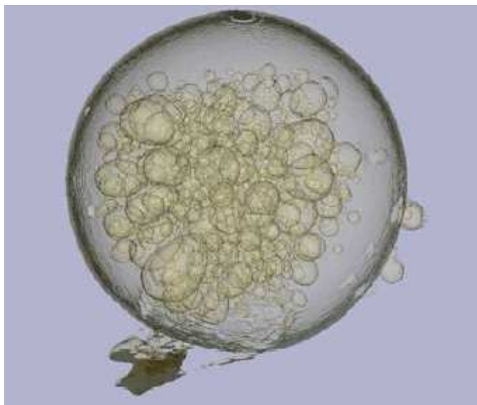
Figure 2.12. Vista tomografica a raggi X di olio incapsulato all'interno di microparticelle di silice pura [Immagine cortesemente concessa dalla CeramiSphere Ltd ].
