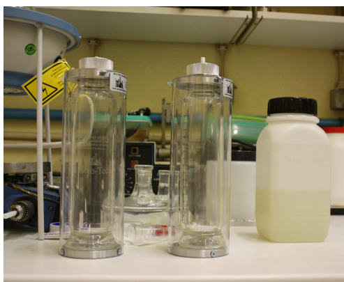
Figura 3.11. Cans di vetro trasparente adoperate per i test con le schiume poliuretaniche.
