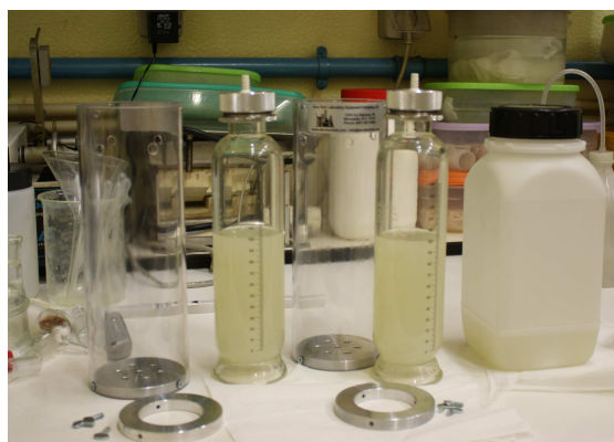
Figura 3.11. Cans di vetro trasparente adoperate per i test con le schiume poliuretaniche.
