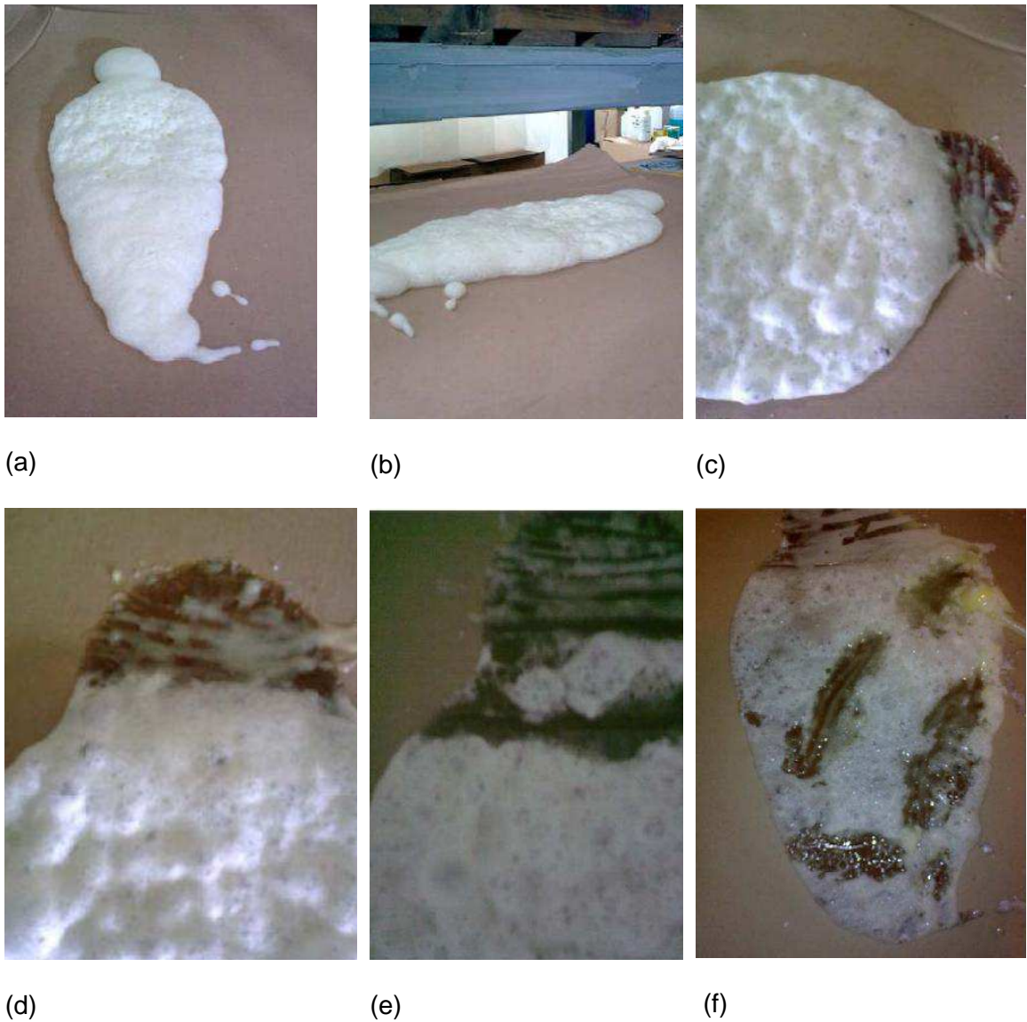
Figura 3.12. Immagini che attestano i momenti successivi all'erogazione della schiuma dalla lattina, contenente USPER come backbone . (a) immediatamente dopo l'erogazione; (b) 30 minuti dopo l'erogazione; (c) e (d) 60 minuti dopo l'erogazione; (e) 90 minuti dopo l'erogazione; (f) 180 minuti dopo l'erogazione.
