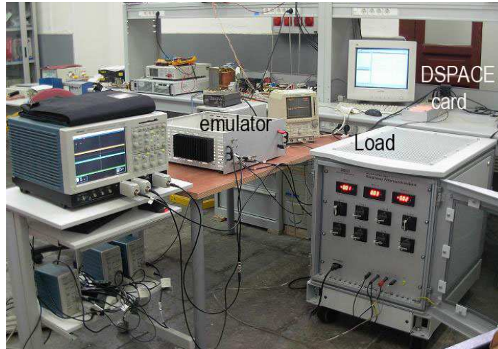
Figura 3.5: Fotografia dell'emulatore FCS con DSpace e carico
