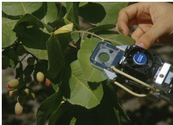
Figura 12. Misurazione degli scambi gassosi della foglia con CIRAS 2
