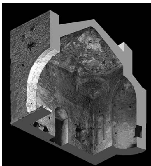
Figura 10 Capilla en el castillo de Montalbano Elicona, axonometría de la nube de puntos (escaneado laser 3D realizado con escáner Leica HDS 7000; autor Mirco Cannella 2013)
