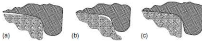
Figura 5.7 - Punti di contatto ruota . rotaia
