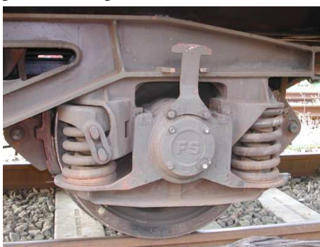
Figura 5.30 - Carrello Y 25 Particolare del Rodiggio
