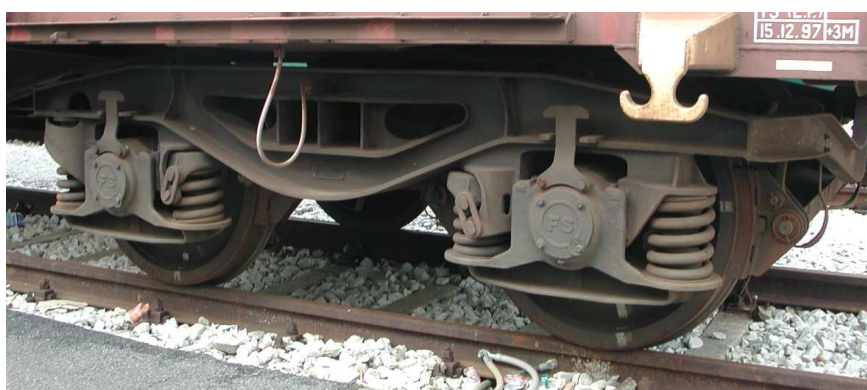
Figura 5.29 - Carrello tipo Y 25: Esempio
