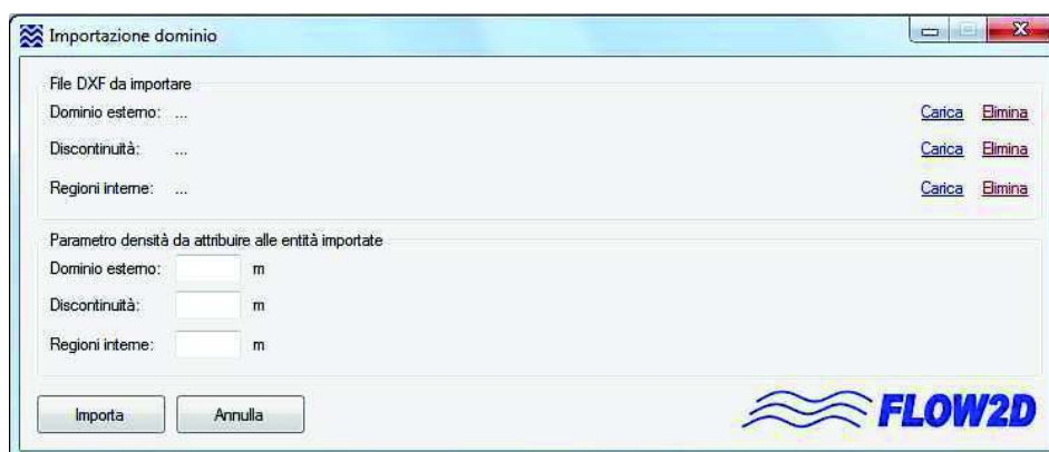
Figura 7.6. Finestra per l'importazione delle entità geometriche costituenti il dominio di calcolo, sottoforma di files DXF.
