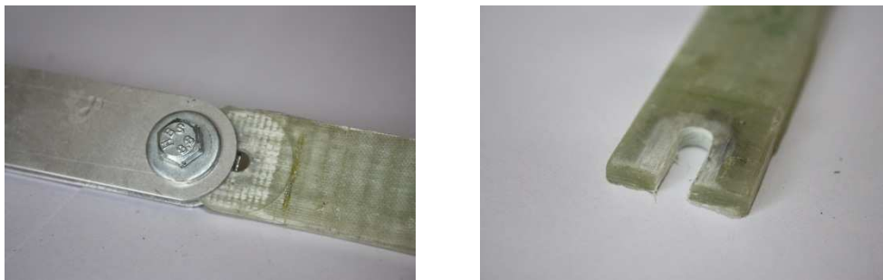
Figure 5: Modalità di rottura caratteristica dei giunti HBB esaminati.
