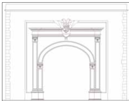
Fig. 10 - Ipotesi ricostruttiva della facciata di porta Vega rivolta verso la piazza d'armi (oggi piazza Kalsa) rivolta
