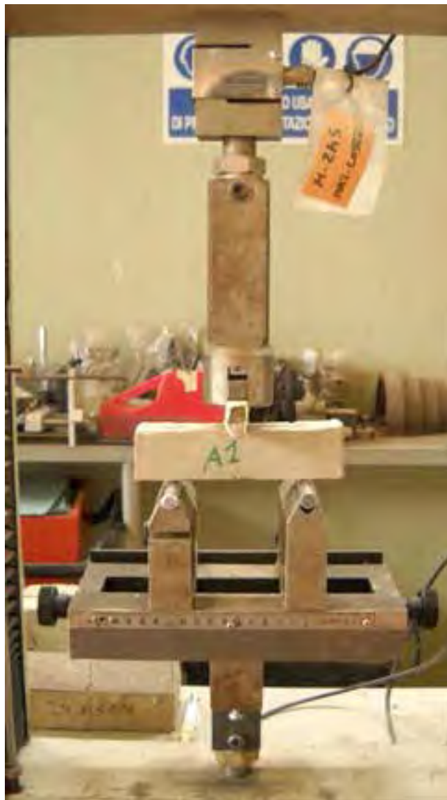
Fig. 15 – Il campione A1 sottoposto a prova di flessione.
