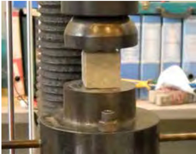
Fig. 5 – Campione sottoposto a prova di resistenza a compressione.
