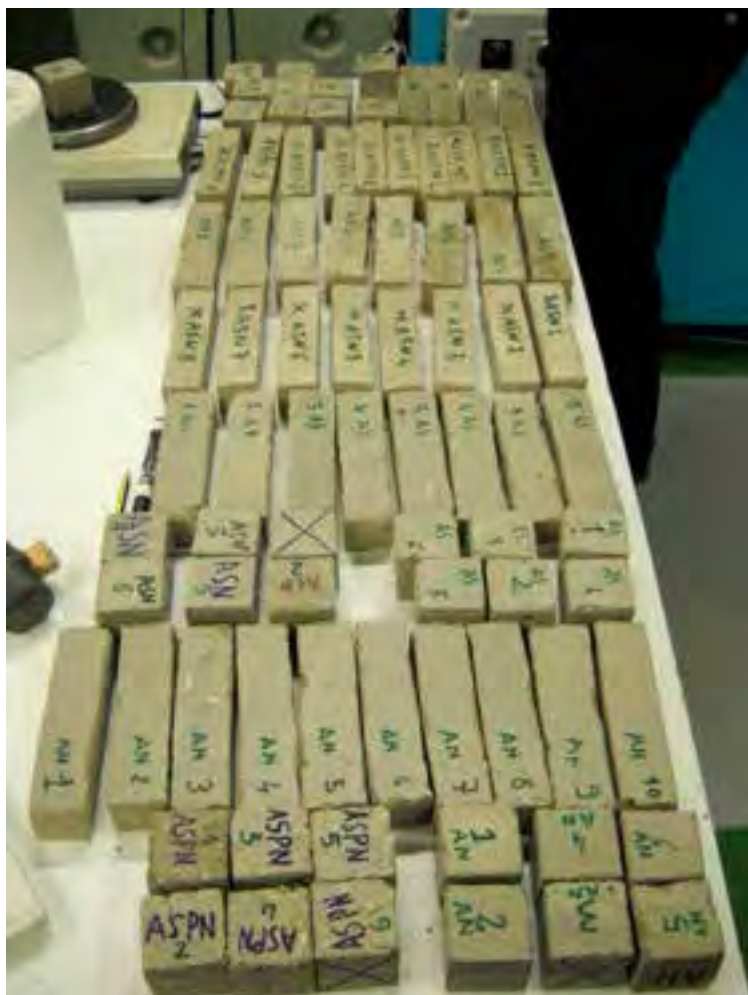
Fig. 2 – I provini da sottoporre alle prove di compressione e di flessione.
