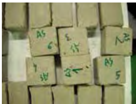
Figg. 3, 4 – I provini da sottoporre alle prove di compressione e di flessione.
