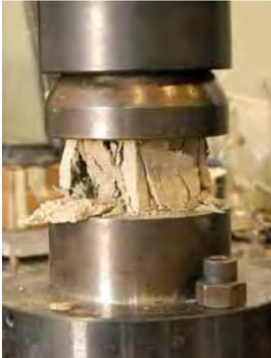
Fig. 7 – Campione sottoposto a prova di resistenza a compressione.
