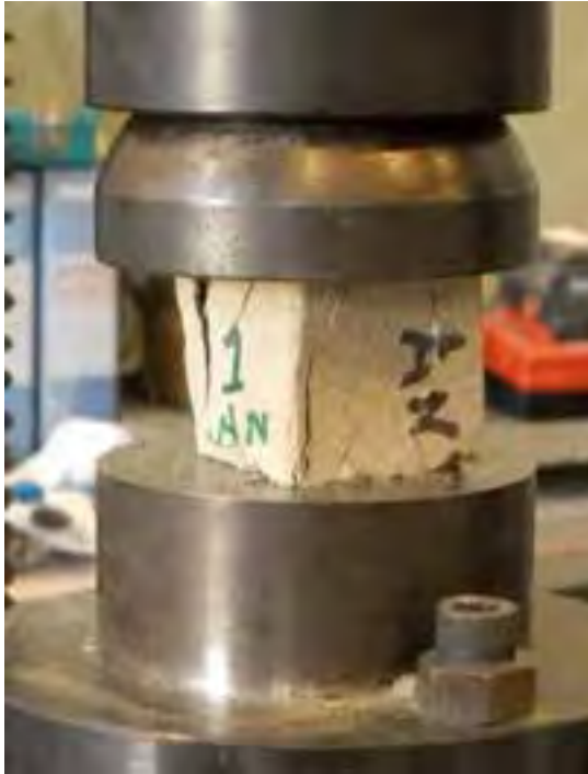
Fig. 12 – Il campione AN1 sottoposto a prova di compressione
