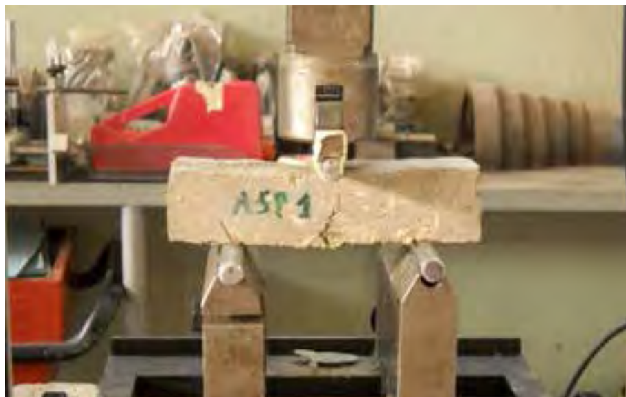
Fig. 19 – Il campione ASP1 sottoposto a flessione.
