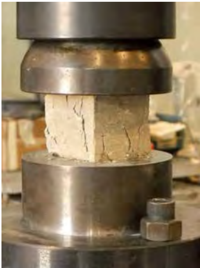
Fig. 6 – Campione sottoposto a prova di resistenza a compressione.
