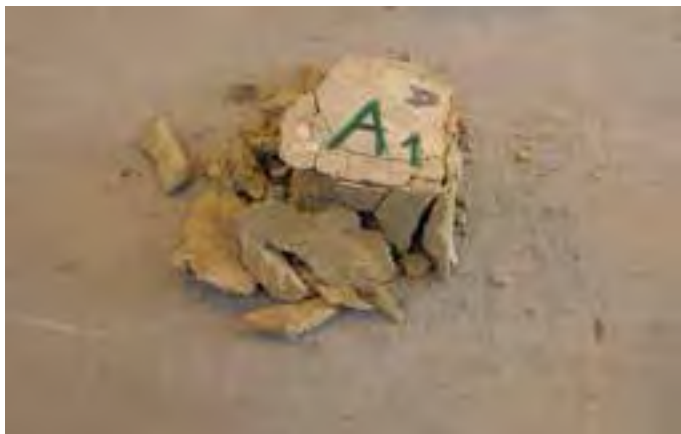
Fig. 9 – Il campione A1 dopo essere stato sottoposto alla prova di compressione.
