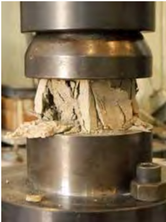
Fig. 8 – Campione sottoposto a prova di resistenza a compressione.
