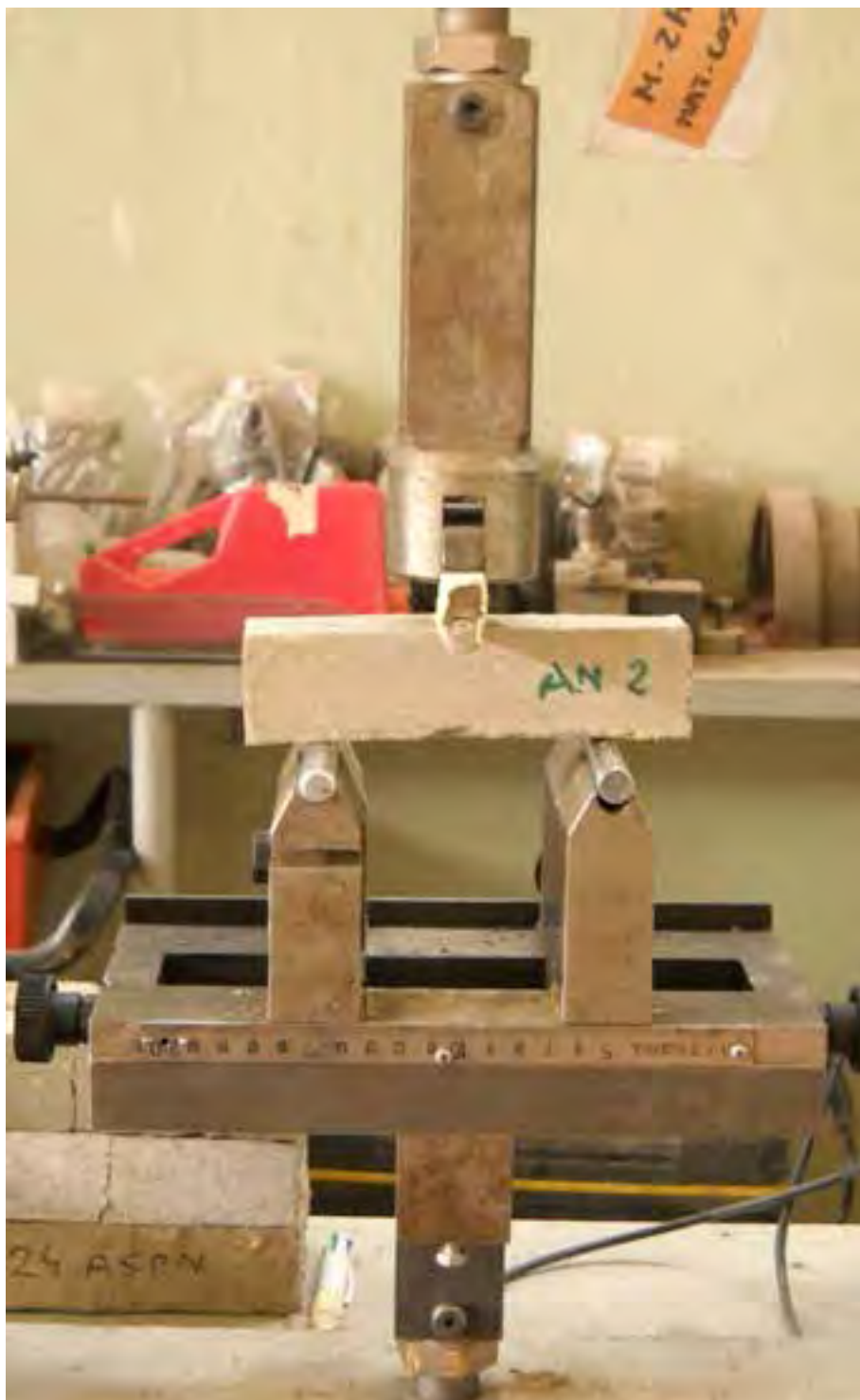
Fig. 18 – Il campione AN2 sottoposto a flessione.
