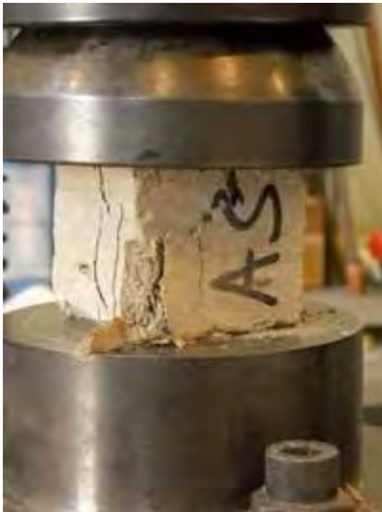
Fig. 13 – Il campione AS2 sottoposto a prova di compressione.
