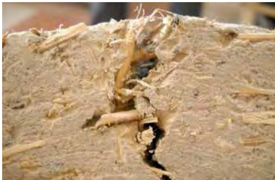
Fig. 20 – Particolare del campione ASP1 dopo la prova di flessione.
