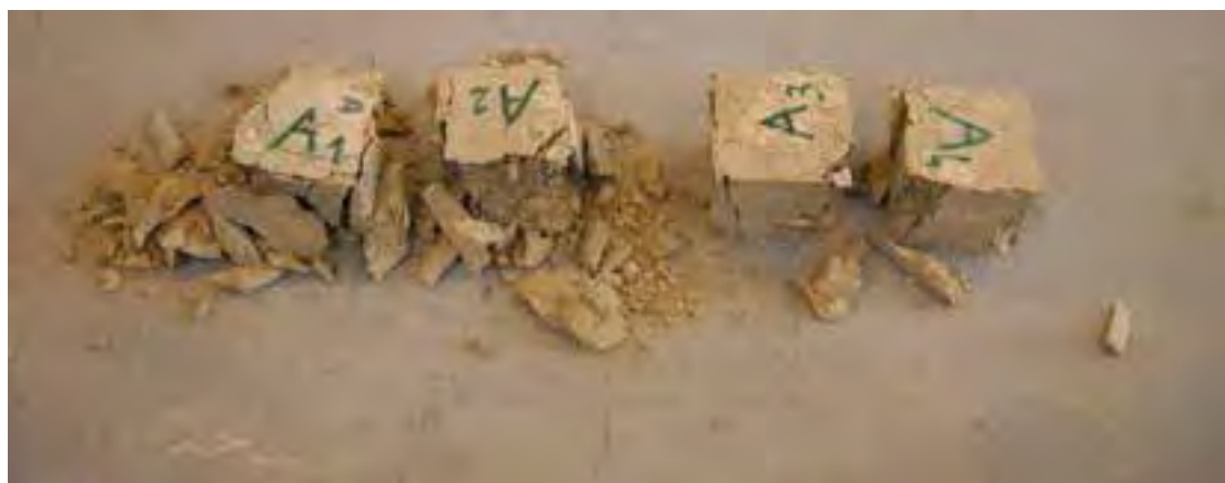
Fig. 10 – I campioni A1, A2, A3 e A4 dopo essere stati sottoposti alla prova di compressione.
