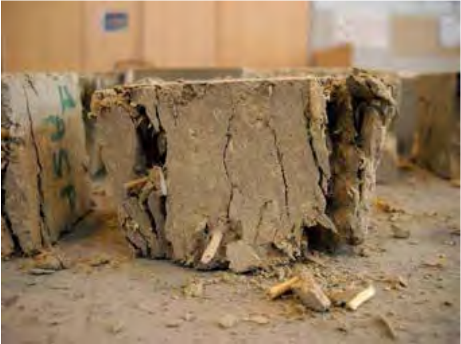
Fig. 14 – I campioni ASP1 e ASP2 dopo essere stati sottoposti a compressione.
