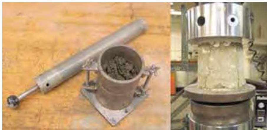
Fig. 1 – Prova a compressione di un campione in terra cruda presso il Dipartimento di Architettura al Massachusetts Institute of Technology.
