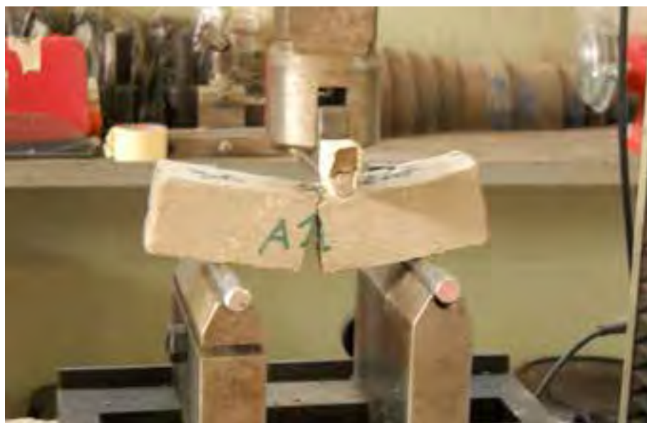
Fig. 17 – Il campione A1 sottoposto a flessione nel momento della rottura.
