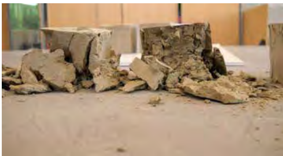
Fig. 11 – I campioni A1 e A2, dopo la prova di resistenza a compressione.
