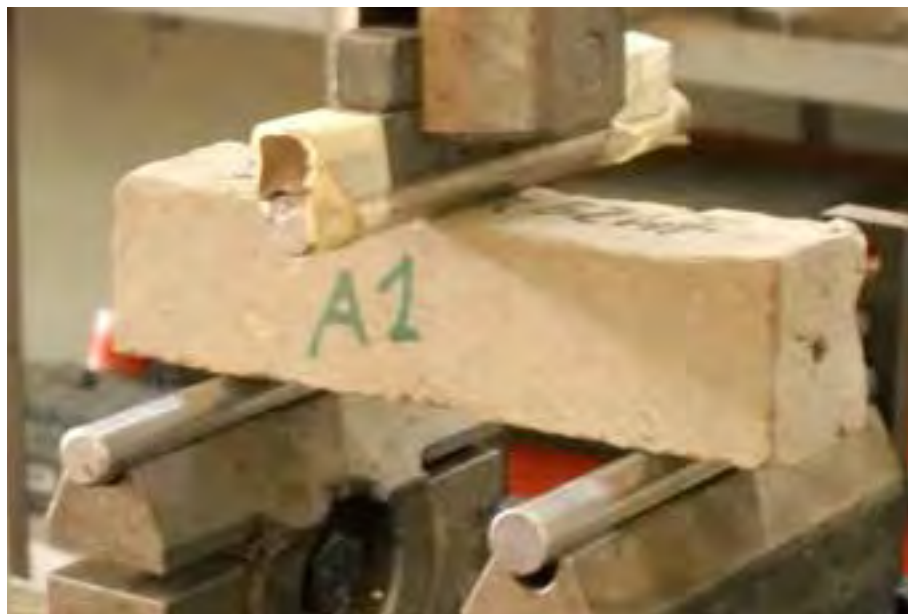
Fig. 16 – Il campione A1 sottoposto a prova di flessione.
