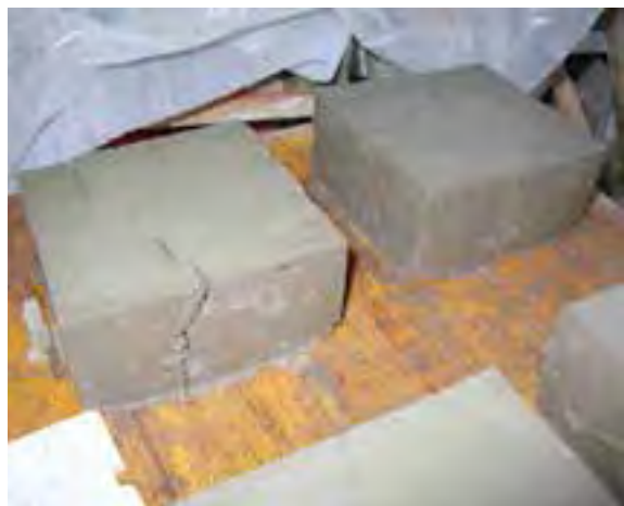
Figg. 72, 73 – Campioni realizzati con l'8% di nanodischi di argilla.
