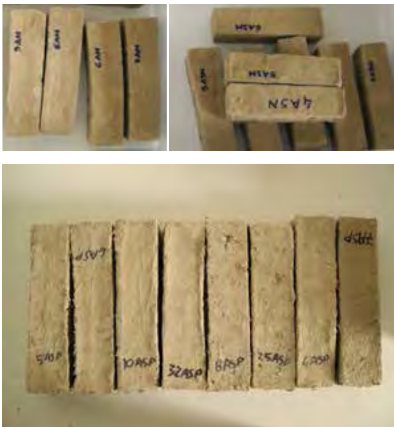
Figg. 74, 76 – Campioni realizzati con il 5% di nanodischi di argilla.
