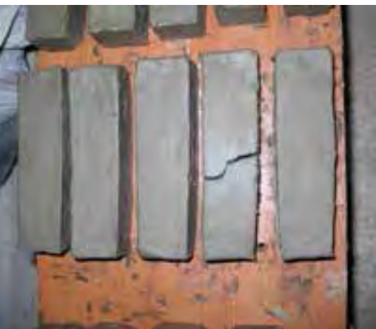
Figg. 72, 73 – Campioni realizzati con l'8% di nanodischi di argilla.
