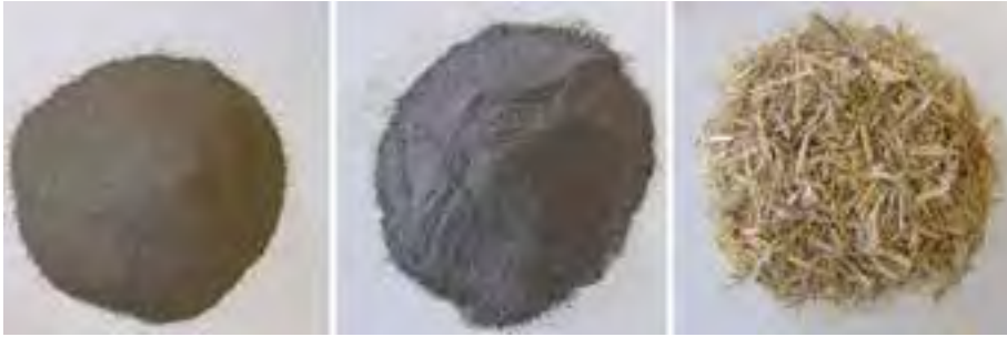
Figg. 1-3 – I materiali forniti dalla Ditta Guglielmino: l'argilla, l'aggregato lavico da 0 a 2 mm e la paglia tagliata mediamente a mm 15.
