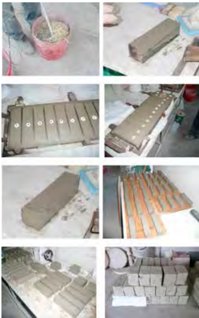
Figg. 8-15 – La realizzazione dei campioni in terracuda nello stabilimento della Ditta Guglielmino a Misterbianco (CT).
