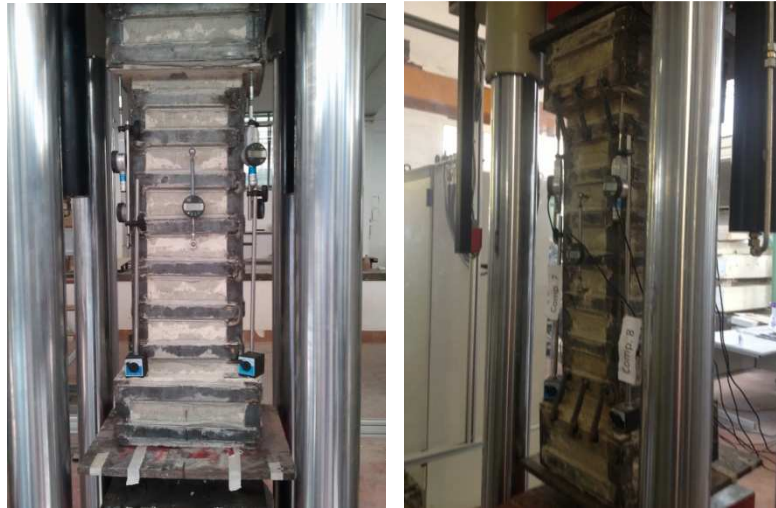
Figura 6.2 – Colonne rinforzate sotto prova
