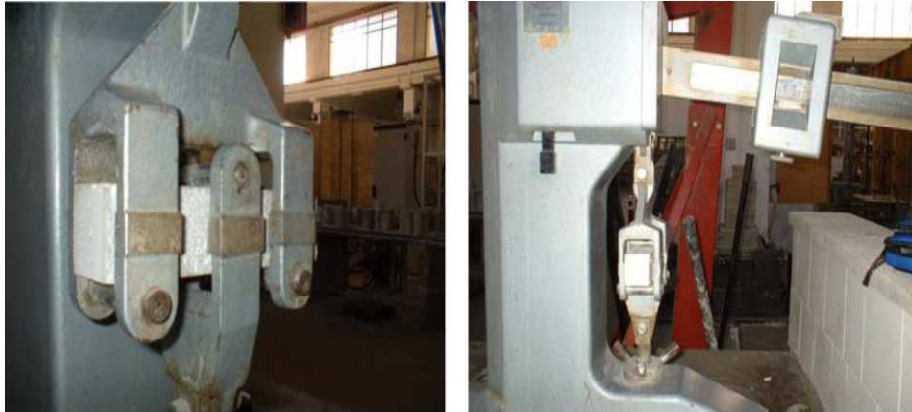
Figura 7.4 – Prova di flessione su campioni di malta
