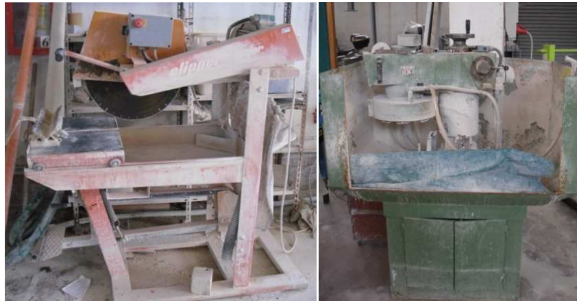
Figura 2.23 – Dispositivi utilizzati per la regolarizzazione dei provini cilindrici: sega rotante e spianatrice
