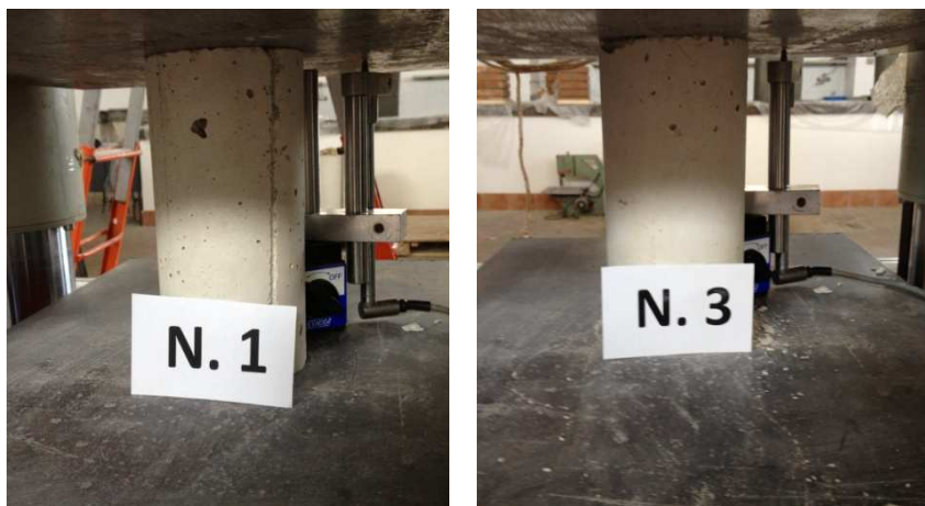
Figura 3.5 - Provini cilindrici per il calcestruzzo colonne della terza serie
