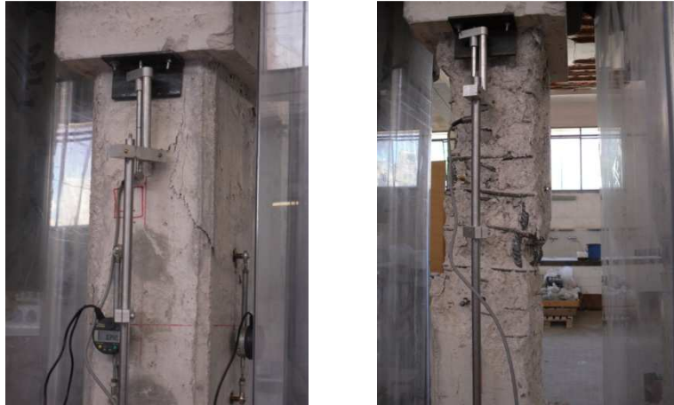
Figura 2.29 – Uno dei campioni della I serie sotto prova
