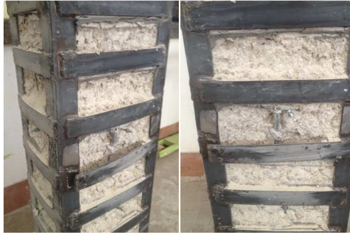
Figura 3.13 - Modalità di rottura, colonna Terza Serie
