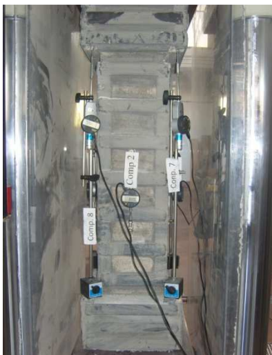
Figura 3.4 – Colonna rinforzata sotto prova.
