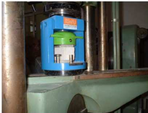
Figura 7.5 – Prova di compressione su campioni di malta
