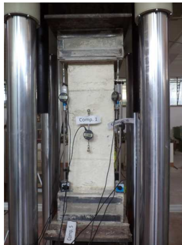
Figura 4.6 – Colonna soggetta a pressoflessione
