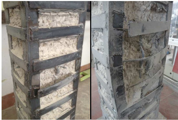
Figura 3.12 - Modalità di rottura, colonne seconda Serie
