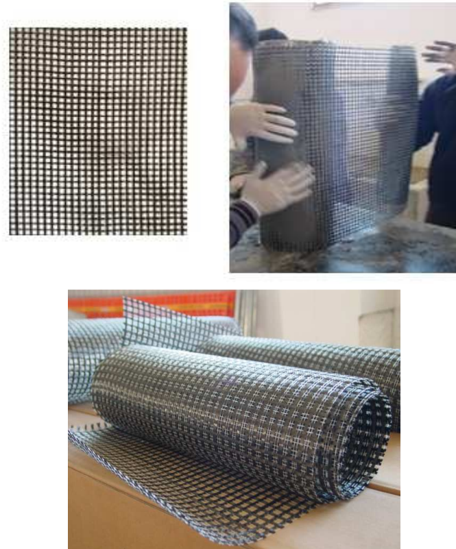
Figura 7.3 – Fibra di carbonio usata ed applicazione del rinforzo FRM
