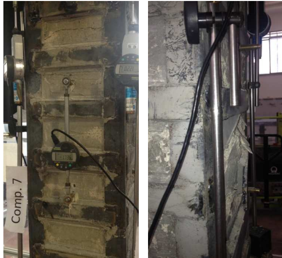
Figura 6.8 – Modalità di rottura, colonna CEIIIYR1
