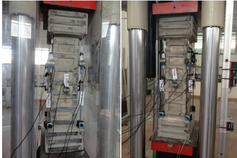
Figura 3.6 - Colonne rinforzate sotto prova
