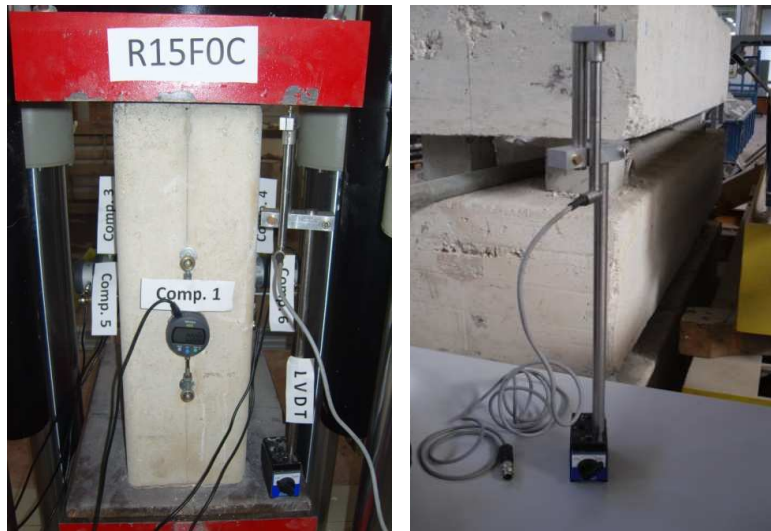
Figura 7.6- Disposizione comparatori ed LVDT
