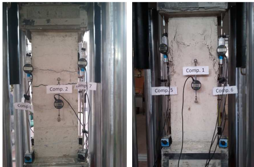
Figura 4.35 - Lesioni nella zona tesa e nella zona compressa
