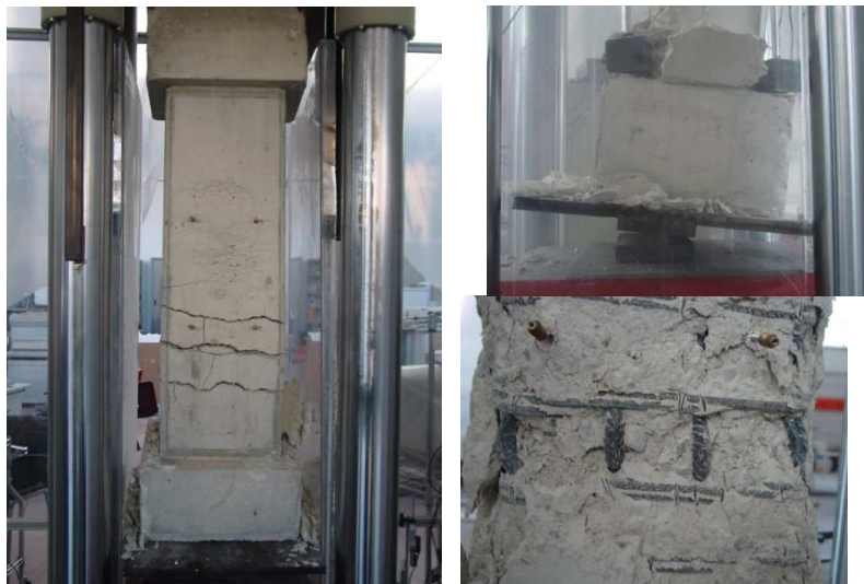
Figura 4.15 – Modalità di rottura, rotazione dell'estremità della colonna
