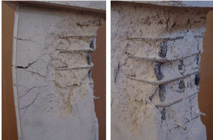
Figura 4.22 – Modalità di rottura di uno dei campioni provati
