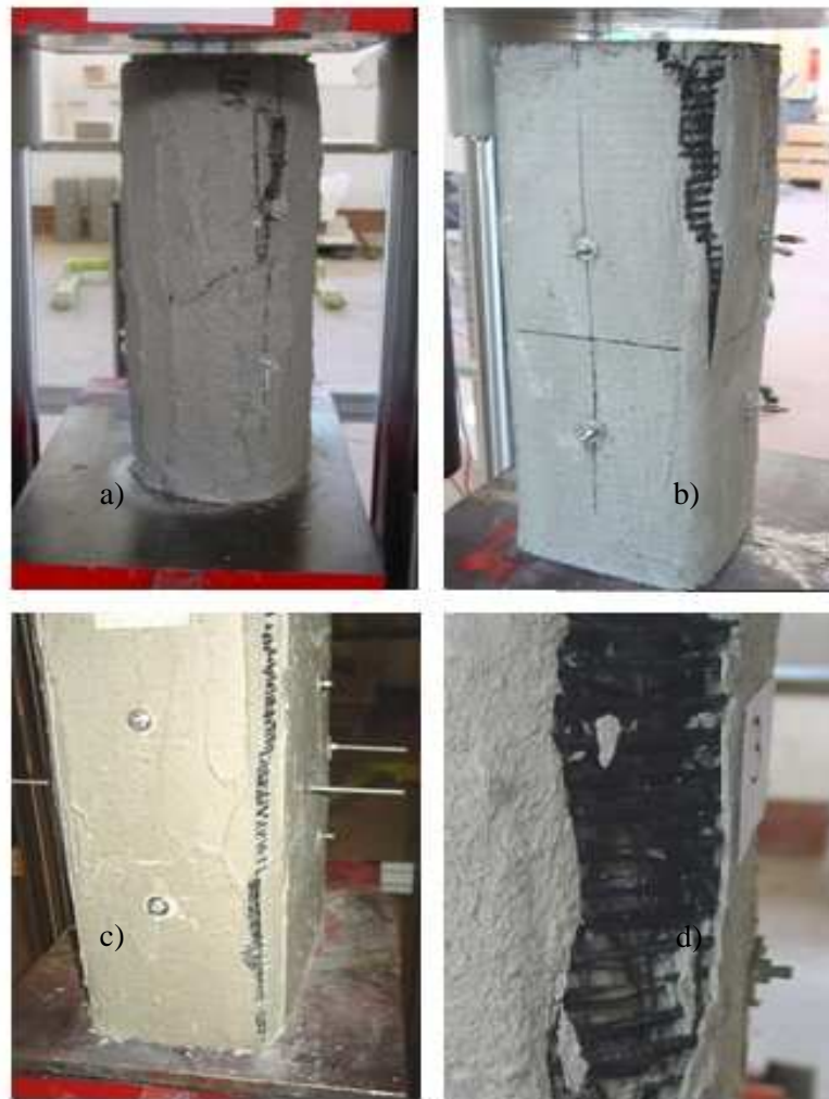
Figura 7.26 - Modalità di collasso per colonne con sez. trasversale: a) circolare, b) quadrata, c) rettangolare, d) particolare del collasso della rete in fibra di carbonio.
