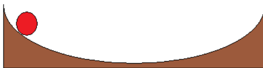
Figura 6. Rappresentazione di un pendolo cicloidale: una massa puntiforme m è libera di oscillare lungo una traiettoria cicloidale.
