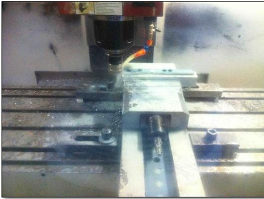
Figura 4.1.2.b – Pezzo in lavorazione alla fresa CNC.
