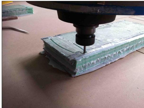
Figura 4.1.1.f – Taglio della nervatura in sandwich.
