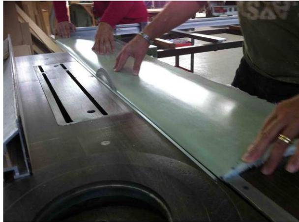
Figura 4.1.1.f – Rifilatura dei laminati.
