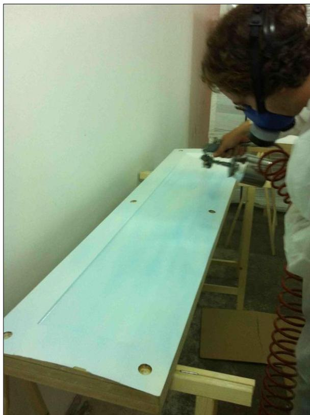
Figura 4.1.1.c – Preparazione dello stampo.
