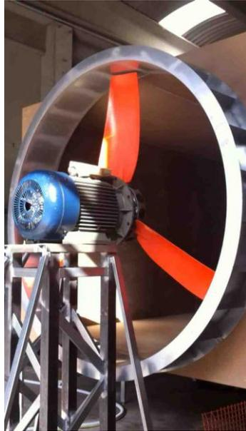
Figura 5.1.f – Il ventilatore con supporto e tamburo.
