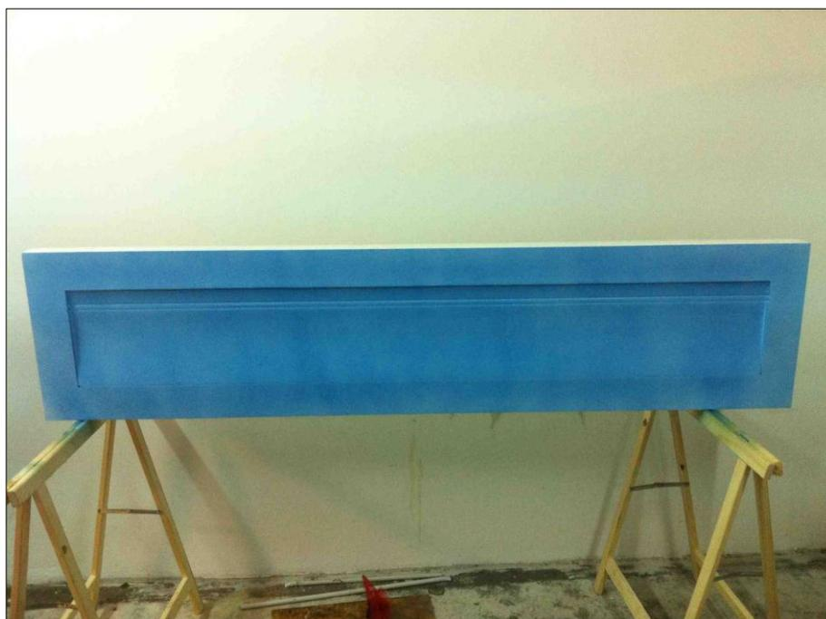
Figura 4.1.1.d – Stampo della pala pronto per la laminazione.
