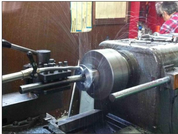
Figura 4.1.2.a – Realizzazione di un componente al tornio manuale.
