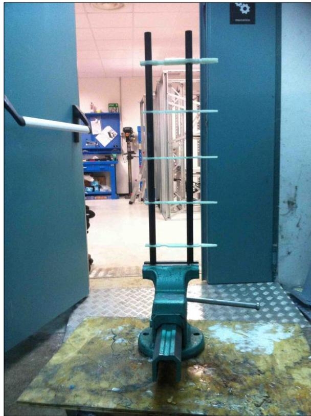
Figura 4.1.1.i – Incollaggio della struttura delle razze.
