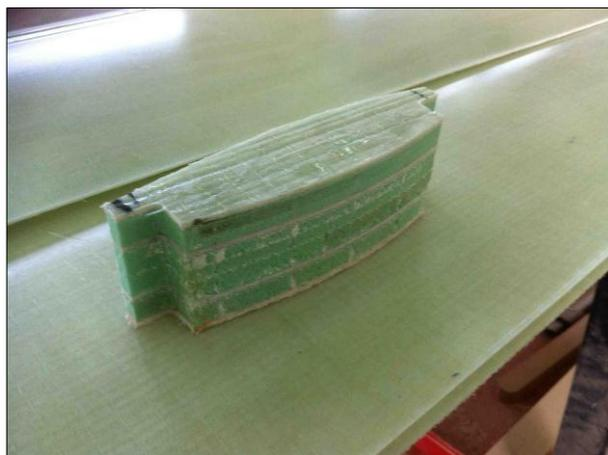
Figura 4.1.1.g – La nervatura in sandwich.
