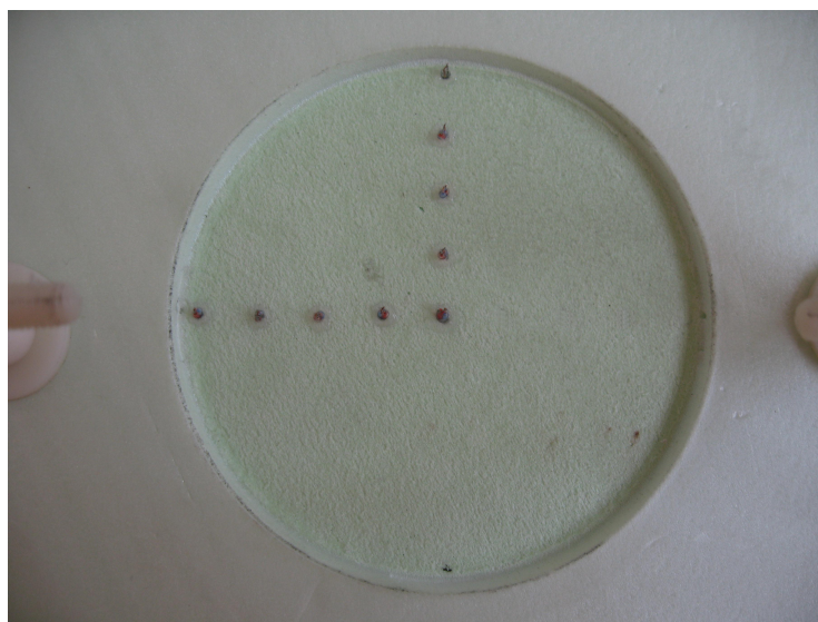
Figura 5.6. Base isolante con termocoppie fissate con opportuno collante
