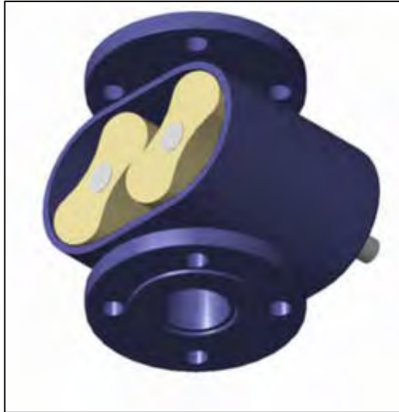
Figura 2.59 - Modello di una pompa per il vuoto Roots generica, caratterizzato dalla camera dello statore e dalla coppia di lobi rotanti.
