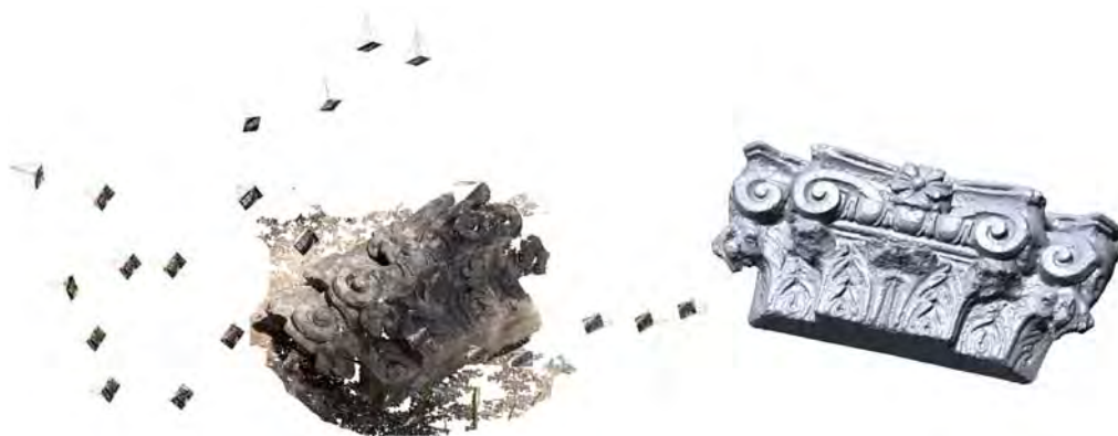
Fig. 8. Rilievo e modellazione di uno dei capitelli del prospetto della chiesa Madre di Salaparuta. A sinistra: schema delle riprese fotografiche e nuvola di punti del blocco. A destra: modello mesh del capitello ricavato dalla nuvola di punti.
