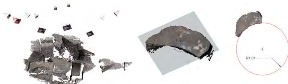
Fig. 7. Rilievo di uno dei concii che costituiscono la superficie curva adiacente agli speroni del prospetto della chiesa Madre di Salaparuta. A sinistra: schema delle riprese fotografiche e nuvola di punti. Al centro, individuazione del piano di attesa e orientamento del concio. A destra: operazioni di misura del raggio di curvatura.
