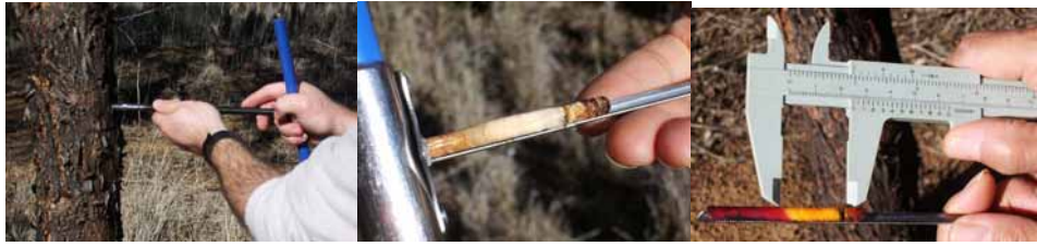
Figura 1.27 - Metodo diretto per la misura dello spessore del sapwood
