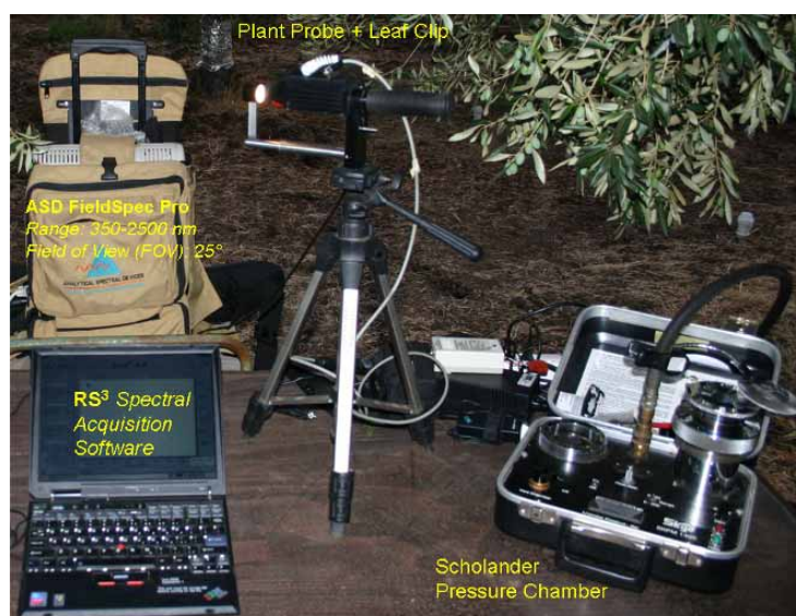
Figura 2.10 – Sistema per l’acquisizione, su singole foglie, delle firme spettrali e dei relativi potenziali idrici
