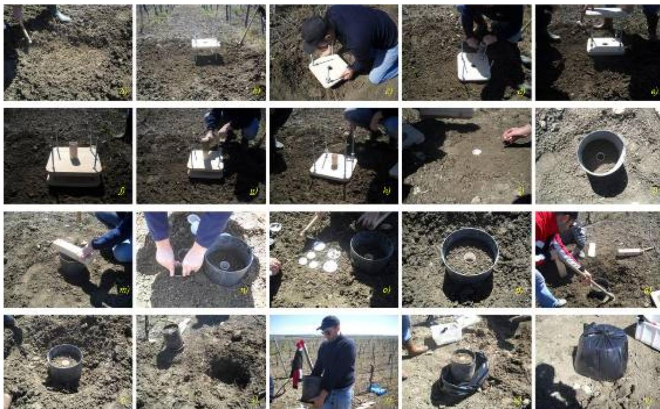
*Figura 2.5 a,v – Fasi del prelievo dei mini-lisimetri indisturbati*
