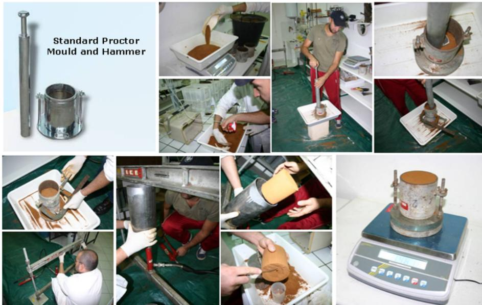
*Figura 2.9 – Procedura di laboratorio per l'identificazione del contenuto idrico del terreno necessario al raggiungimento del valore massimo della massa volumica apparente*
