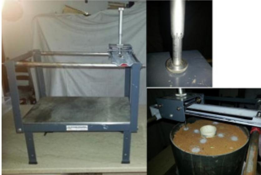
**Figura 2.7 – Installazione sperimentale utilizzata per misurare la contrazione verticale nel corso di un processo di essiccazione all'aria del campione di terreno**
