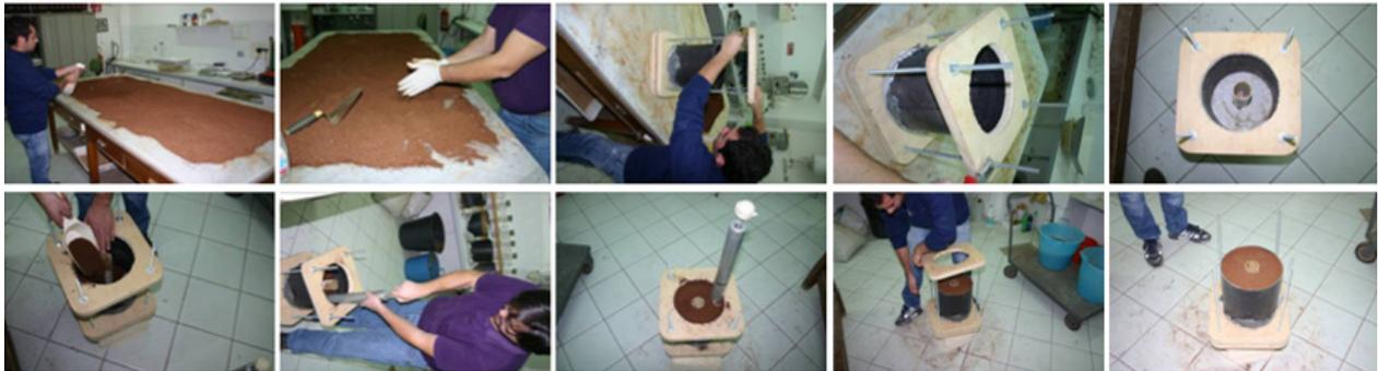
*Figura 2.11 – Procedura di laboratorio per la realizzazione del mini-lisimetro di suolo rimaneggiato a valori prefissati della massa volumica apparente*
