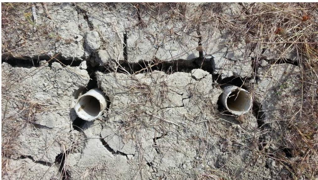
*Figura 3.4 – Crepacciature nell'intorno dei tubi di accesso della sonda Diviner 2000 presenti nel corso della seconda tornata di misure per il suolo PIN*
