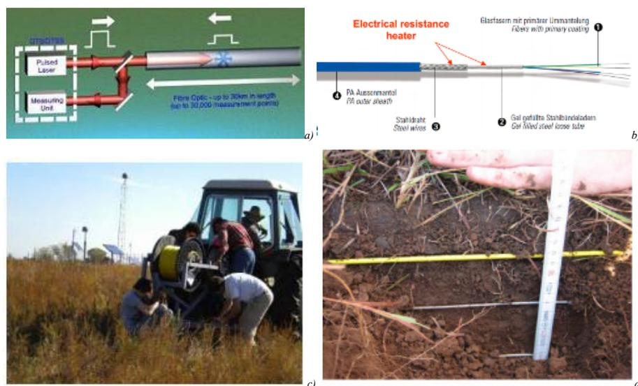
**Figura 1.5 - Schema sintetico del sistema DTS a), particolare della fibra ottica utilizzata nei sistemi attivi b) e installazione del sistema in campo c) e d)**
