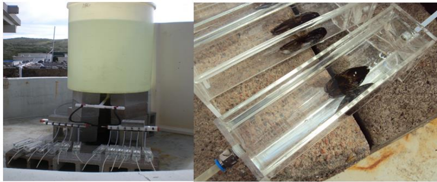
Fig. 10 - (sinistra) Sistema a flusso continuo adoperato a Bodega Bay per il calcolo dei tassi di filtrazione di Mytilus californianus ; (destra) Dettaglio di un mitile che sta attivamente filtrando durante la fase sperimentale
