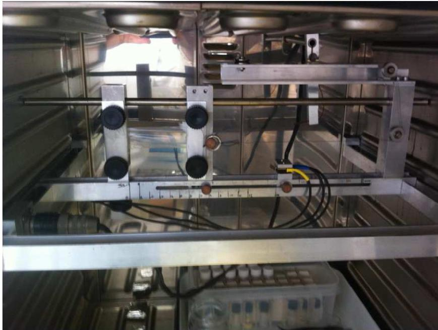
**Figura 5. Apparecchiatura utilizzata per l'allungamento delle nanoparticelle di CSPIBCA**
