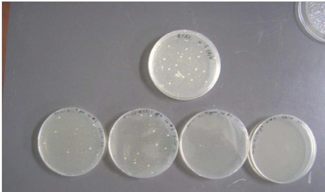
**Figura 16. Piastre di Petri inoculate con CuCS 0.1 mg/ml (1; 2,5; 5; 10 ppm) messe a contatto con la coltura batterica di *E.coli*  $35 \times 10^3$  ufc/ml.**
