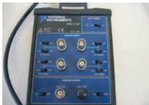
Figura 2.8 – Accessorio BNC-2140 (National Instrument) di interfaccia tra l'amplificatore AD549 e la scheda di campionamento PCI-4551 .
