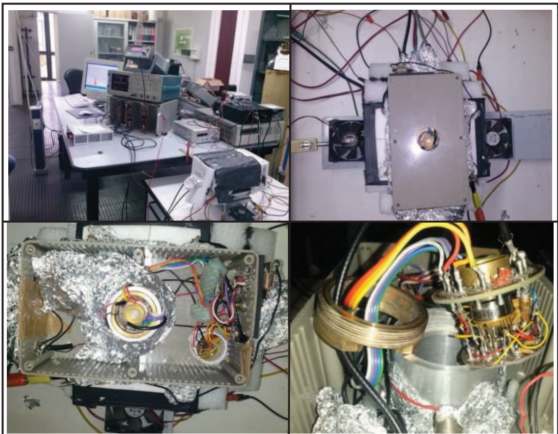
Figura 3.2 – Dettagli del set-up sperimentale per le misure elettriche con sorgenti X.
