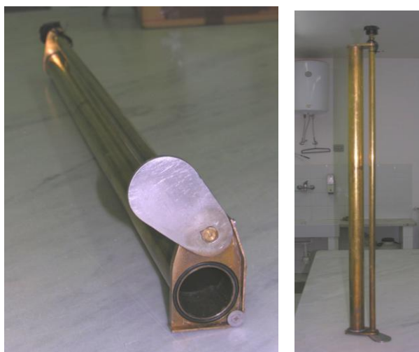
Fig. 4.9 – Viste del campionatore per la misura della perdita di suolo
