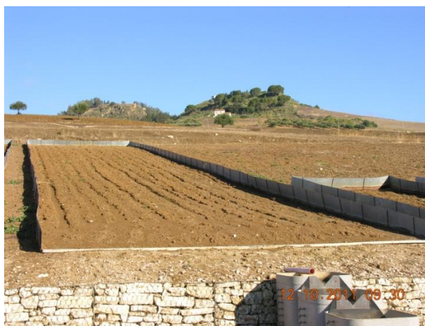
Fig. 4.19 – Formazione di solchi in una parcella sperimentale per la misura dell'erosione
