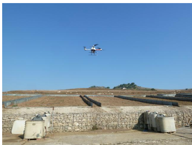
Fig. 4.22 – Drone utilizzato a Sparacia per il rilievo aereo a bassa quota
