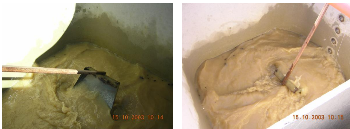
Fig. 4.3 - Agitazione della sospensione durante le operazioni di campionamento in campo
