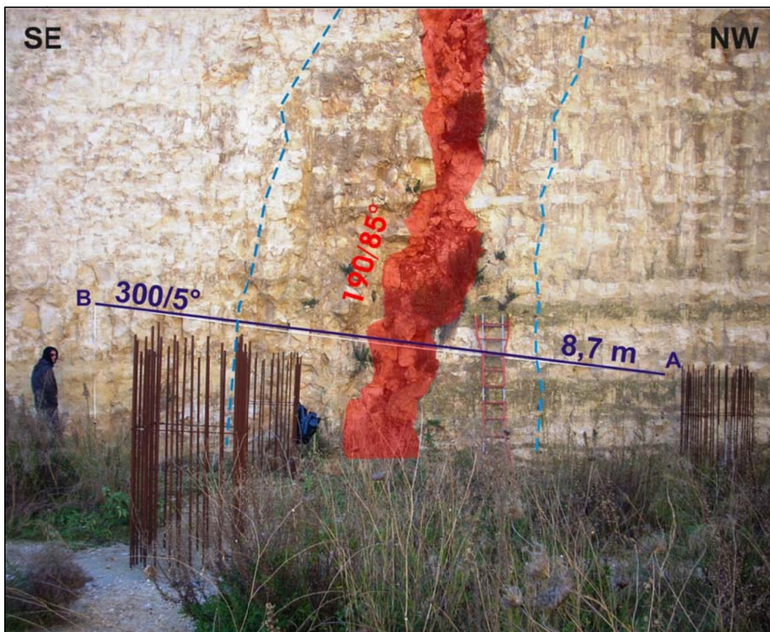
Figura 5.102 – Scan line nella porzione inferiore del membro Irminio: in rosso la core zone ; le linee tratteggiate azzurre limitano la damage zone ; le misure si riferiscono a immersione e inclinazione.
