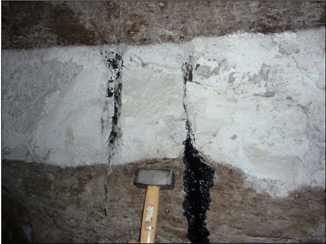
Figura 3.17 – Mb. Irminio - intervallo inferiore (Miniera La Tabuna): impregnazioni bituminose.
