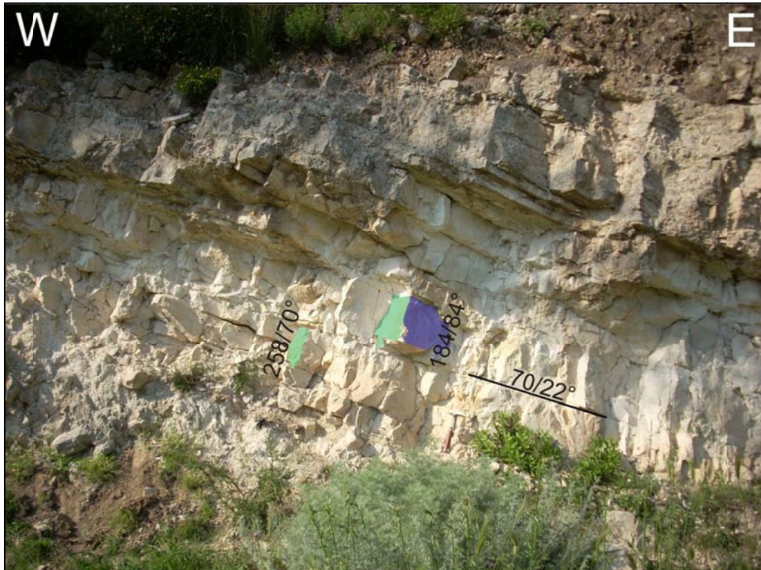
Figura 5.22 – Due set di joint perpendicolari al bedding confinati all'interno degli strati carbonatici (le misure si riferiscono a immersione e inclinazione).
