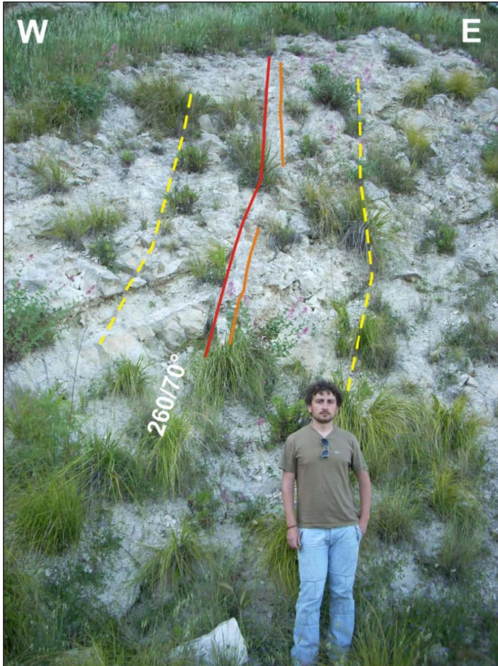
Figura 5.36 – Esempio di “Faglia media” (le misure indicano immersione e inclinazione): la linea rossa indica la superficie di taglio, tra questa e le linee arancioni si vede la core zone , le linee tratteggiate gialle limitano la damage zone .
