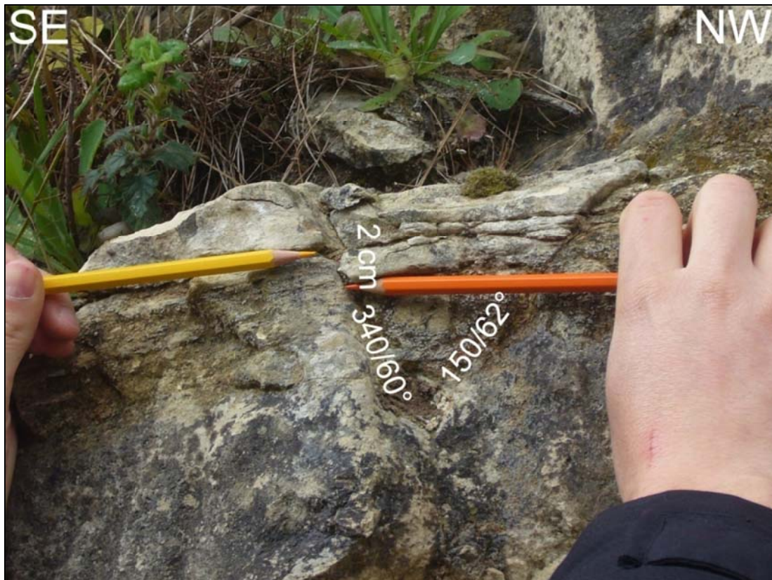
Figura 5.31 – Esempio di “Faglie incipienti” coniugate (le misure indicano immersione e inclinazione).
