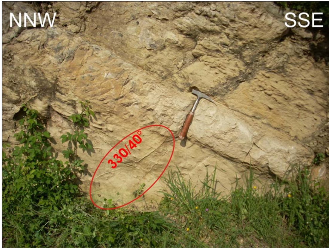
Figura 5.26 – Deformation band nel Sotto-Mb. Irminio inf. (in rosso immersione e inclinazione).
