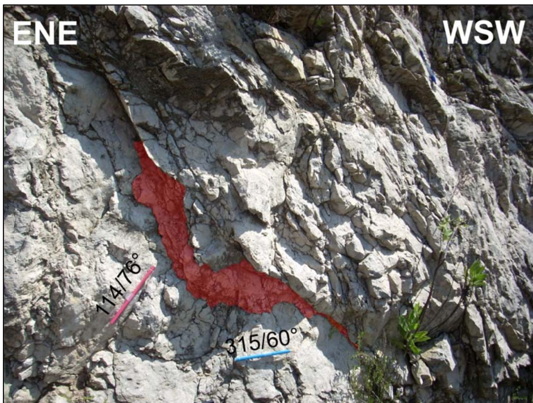
Figura 5.38 – Particolare della fault core della faglia di figura 5.37 (le misure indicano immersione e inclinazione): le matite colorate indicano due diverse superfici di taglio secondarie; in rosso cataclasi lungo la superficie di taglio principale.
