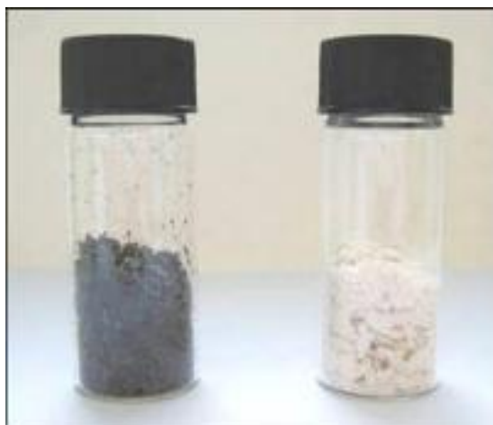
Figura 2.7 Prodotto grezzo contaminato della reazione di Suzuki-Miyaura catalizzata da \text{Pd}(\text{OAc})_2 (sinistra), e il prodotto grezzo ottenuto con \text{PdEnCat}^{\text{®}}30 (destra)
