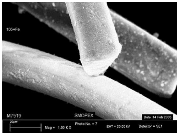
Figura 2.5 Immagine SEM ( scanning electron microscope ) di fibre di SMOPEX ® . Scala 20 µm.
