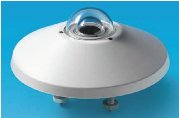
Figura 18 – Piranometro a termopila classificato come Secondary Standard (ISO9060) e relative caratteristiche.
