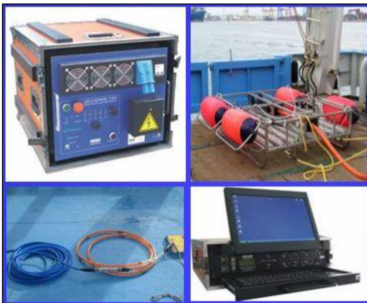
Figura 8.2.1.1 - Sistema di energizzazione sparker
