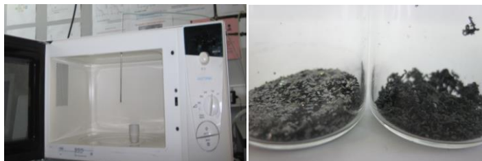
Fig. 2.2: il fornetto a microonde usato per l'espansione dei GIC (a sinistra) ed il campione prima e dopo il trattamento (a destra)
