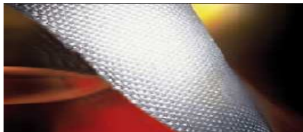
Figura 2: Tessuto di allumina tipo "fabric" 2D Satin 8H Nextel 610.
