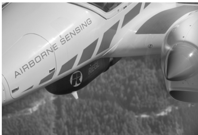
Figura 5.2 - Laser scanner montato su un velivolo leggero.
