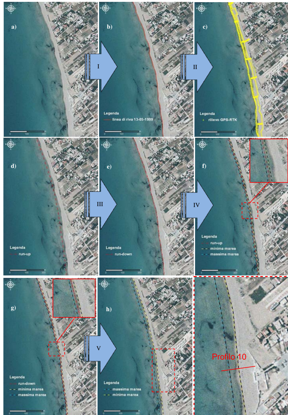
Figura 7.50 - Sequenza per individuare la fascia d'incertezza nell'immagine aerea (Volo Italia 2000). a) immagine aerea; b) linea di riva (ldr) istantanea; c) ldr ottenuta attraverso il rilievo topografico; d) run-up; e) run-down; f) run-up e effetto marea; g) run-down e effetto marea; h) fascia d'incertezza.
