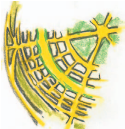
Lo schema della città giardino di Ebenezer Howard (1898), di cui viene raccomandata un'applicazione con adattamenti ai casi specifici, prevede tra l'altro: la definizione di sei boulevards di 36 m, al centro un parco circondato da edifici pubblici, una grande Avenue di 130 m che sostiene residenze .
