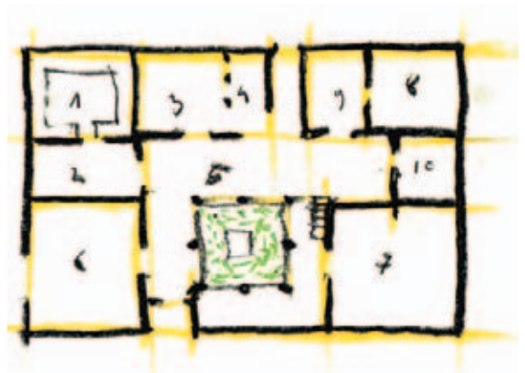
Olinto, la casa detta della «buona fortuna». Sono distinguibili: un ingresso principale a Sud e uno secondario a Nord che immettono entrambi direttamente in un portico (5) che dà su di un cortile con altare centrale (in verde), una sala pranzo con panca (1) a cui si accede attraverso un vestibolo (2), la cucina (3) con il focolare (4), un magazzino a quota più bassa (6), e altri ambienti (7, 8, 9, 10). Lo schema, molto regolare nel riproporre l'impianto della casa a corte, ne accentua i caratteri introducendo un elemento di forte rappresentatività definito dal portico. Anche questa casa non presenta aperture verso l'esterno tranne che per i due ingressi. Messa a confronto con le altre due case definite dal medesimo impianto di insule ippodamee appare per lo meno di dimensioni doppie. Questo dimostra le potenzialità di adattamento dell'impianto regolare definito dalla scacchiera delle città ellenistiche di impianto ippodameo.
