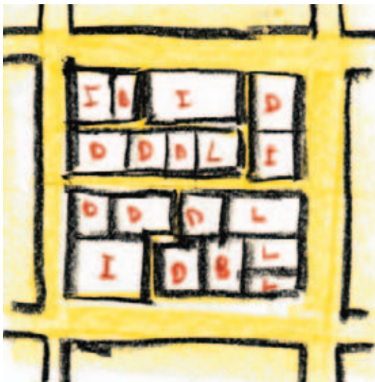
Un isolato dell'impianto della città romana attraversato da strade e vicoli di minori dimensioni rispetto a quelle principali e che aggrega corpi di fabbrica di varia grandezza e tipologia definiti da insulae (I), domus (D), botteghe (B) e laboratorii (L). Questa natura dell'isolato della città romana registra la composizione sociale complessa della comunità insediata. La regolarità dell'impianto deriva dalla cultura ellenistica, le forme e i modi di abitarlo sono propri di una società socialmente più articolata, ma anche capace di reggere, senza nette separazioni, le differenti classi sociali che ospita.
