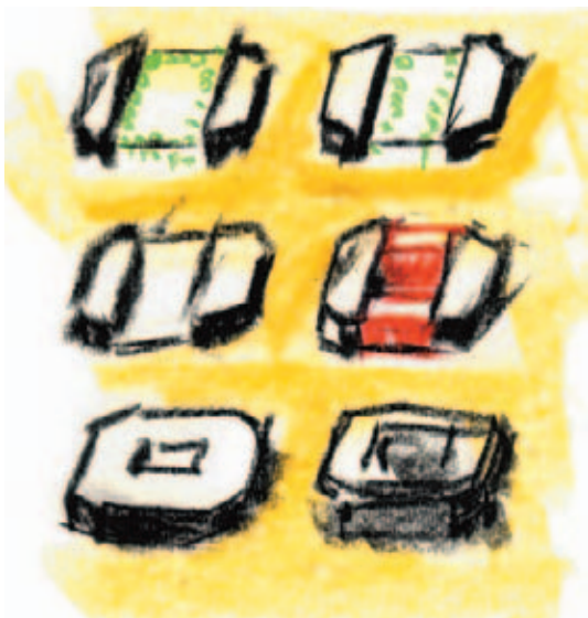
Il processo di densificazione dell'isolato di Barcellona dimostra come da 67.200 m 3 definiti nella versione originaria del piano si passa, nell'ultima fase a 294.771,61 m 3 , anche grazie alla costruzione di una o più sopraelevazioni. Viene portata l'altezza costruibile da 16 a 23 m e la profondità da 20 a 28 m.
