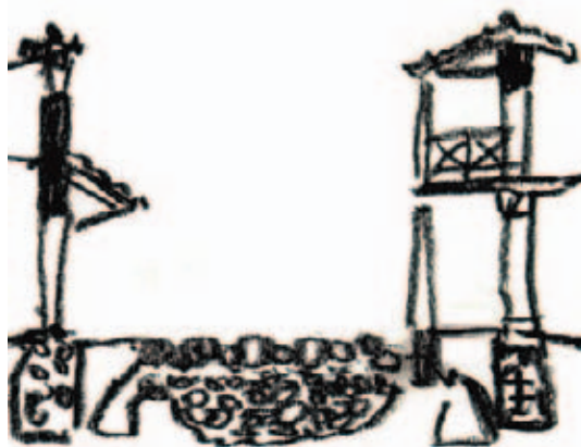
Una strada della città romana in uno schizzo prospettico e in una sezione tipo. Grandi costruttori di ponti e di acquedotti, i romani furono anche ed essenzialmente costruttori di strade. Le strade delle città erano tutte lastricate con grandi blocchi di pietra tra loro connessi e orditi su di un sottofondo formato da materiale lapideo informe che permetteva un corretto drenaggio delle acque meteoriche. Sotteraneamente, lungo il loro tracciato, scorrevano condotti (cloaca) che servivano a smaltire i liquami. Altri condotti di acqua potabile servivano le pubbliche fontane, le terme e alcune domus .
