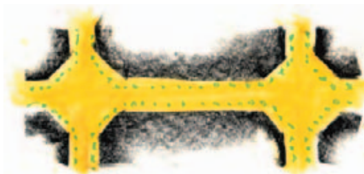
Cerdá definisce per il piano di Barcellona degli isolati con gli angoli smussati a 45°, così da consentire la massima visibilità agli incroci. L'attenzione matematica alle misure della città e alle forme insediative viene ampiamente sviluppata nel testo «Teoria generale dell'urbanizzazione».
