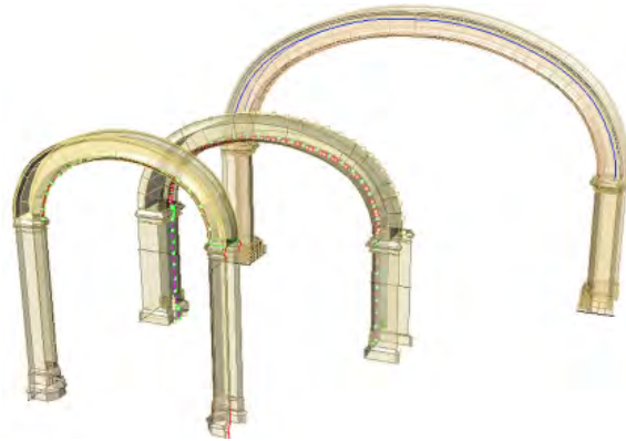
Fig. 6. 36 - Modellazione degli archi ribassati della chiesa di Santa Maria dello Spasimo, del palazzo Abatellis e del palazzo Ajutamicristo.
