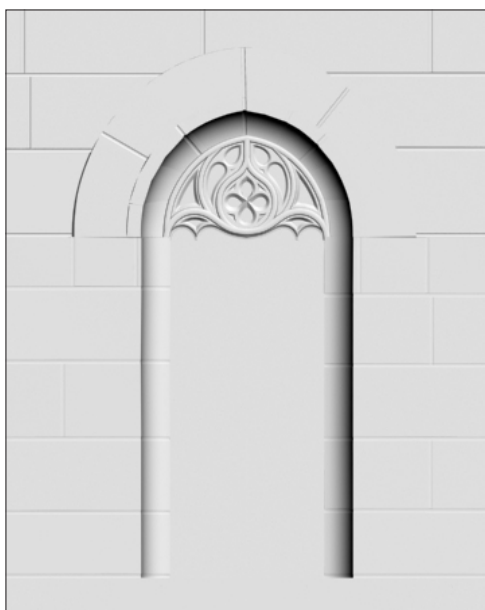
Fig. 6.59 - il modello matematico digitale ultimato in ambiente CAD, pronto per la conversione delle superfici in mesh . Operazione, quest'ultima, necessaria per l'esportazione in formato stl , compatibile con il software di gestione della macchina RP per la produzione in scala 1:10 del prototipo.
