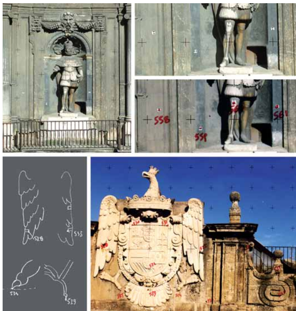
Fig. 4. In alto, punti d’appoggio materializzati con l’ausilio di segnali codificati; in basso, punti d’appoggio posti in punti ben riconoscibili sui fotogrammi.
