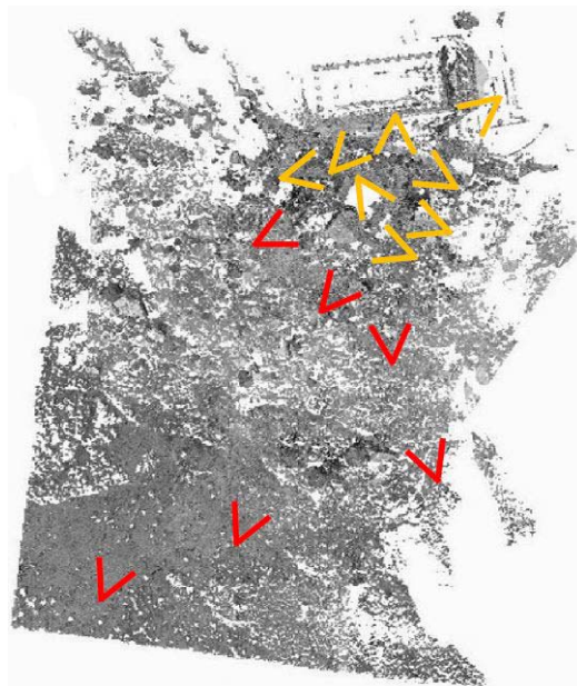
Figura 2 – Schema dei punti stazione delle scansioni laser (in rosso le posizioni di scansione della parte bassa, in giallo quelle eseguite dalla parte più alta del versante).
