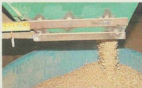
▲ Fig. 10 - Vista della tramoggia (a sinistra) e della regolazione grossolana della luce libera di caduta della granella.
